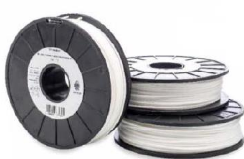
Figura 4-2 Bobina de ABS RAL 9003 usada para la fabricación de probetas [30]
