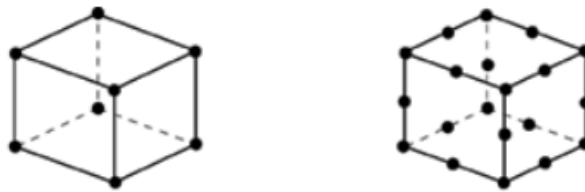
Figura 3-1 Elemento lineal con 8 nodos y elemento de segundo orden con 20 nodos [9]
