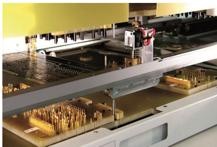
Figura 1.13. Implementación test cama de agujas.
