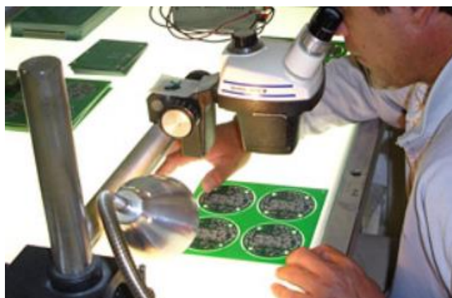
Figura 1.4. Inspección visual llevada a cabo por un operario.
