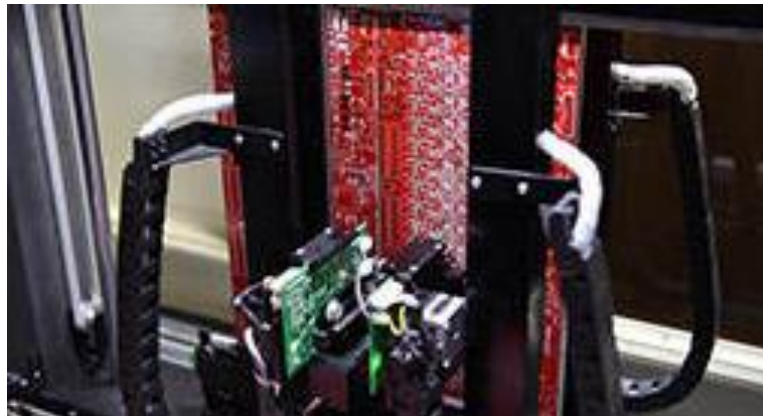
Figura 1.11. Implementación real del test de sonda volante.
