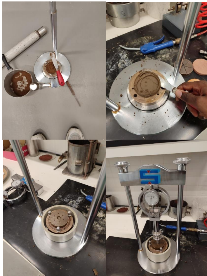
Figura 77. Detalles del procedimiento de realización del ensayo para la determinación de la expansividad de un suelo en el aparato Lambe. Fuente: propia.
