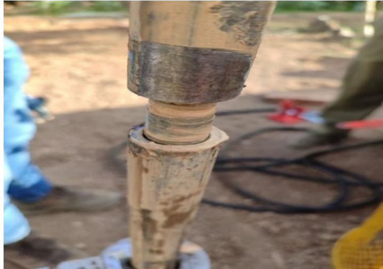
Figura 43. Detalle del varillaje al alcanzar el nivel freático en el primer penetro realizado. Fuente: propia
