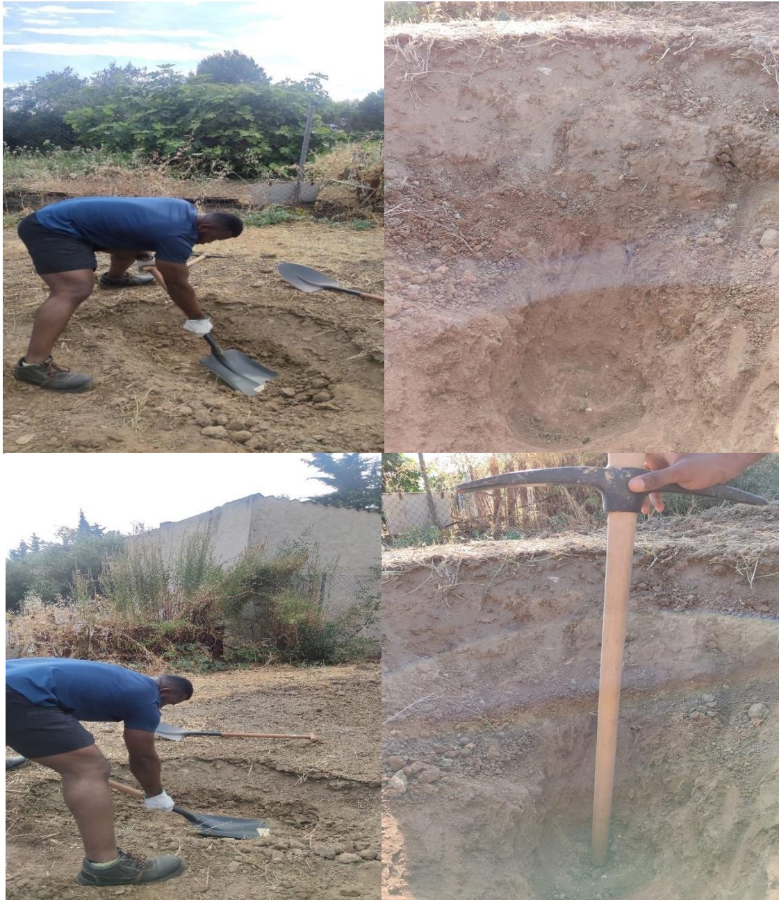
Figura 49. Campaña de recogida de material cada 20 cm para ensayos de laboratorio. Fuente: propia
