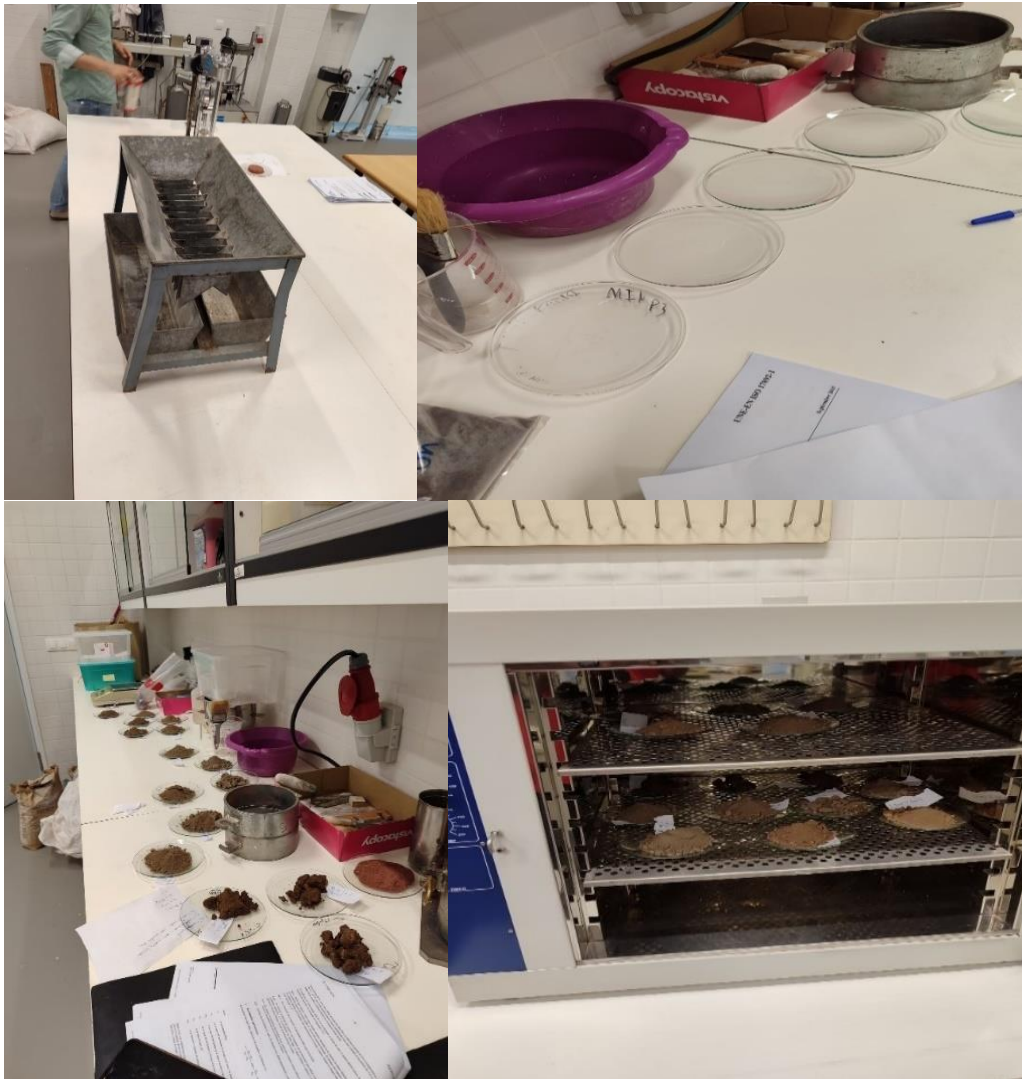
Figura 51. Detalles del ensayo de determinación de la humedad: cuarteador de muestras; vidrios de reloj para muestras; muestras preparadas antes de estufa; estufa con las muestras tras el ensayo. Fuente: propia
