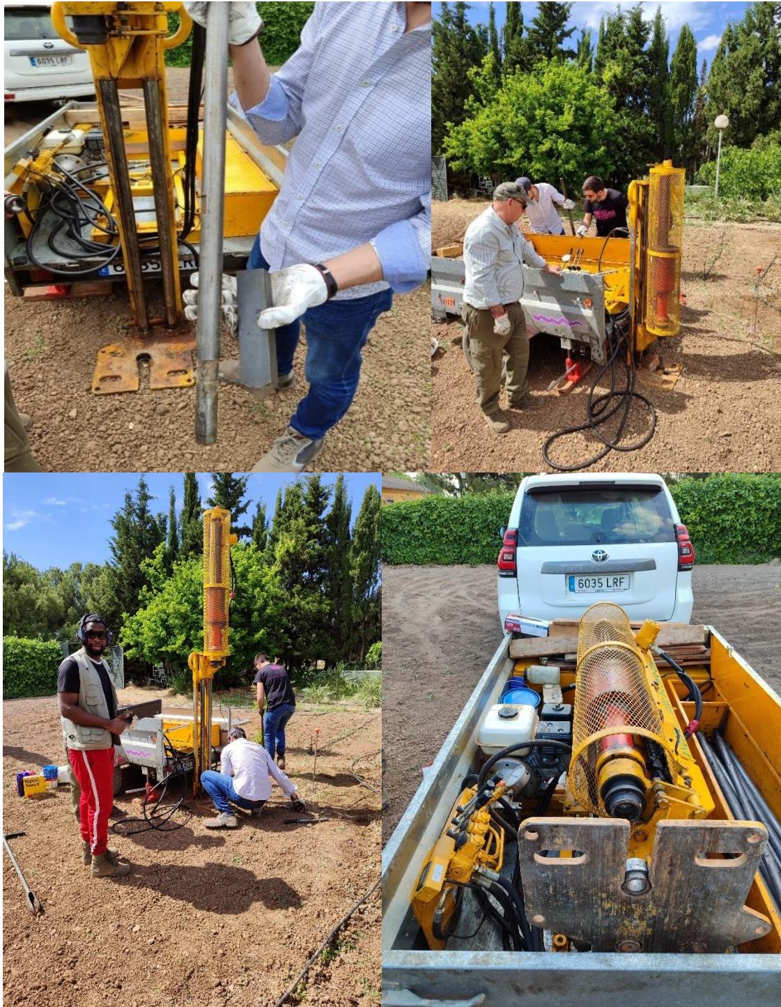
Figura 39. Equipamiento completo, mecanismo de elevación, arranque del equipo, varilla y puntaza, muestra de señalización cada 20 cm, funcionamiento del equipo. Fuente: propia
