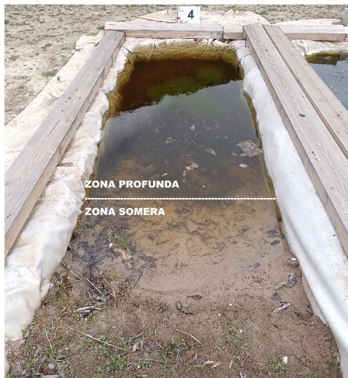
Figura 4.1.1. Ejemplo de uno de los mesocosmos construidos con las dos zonas señaladas. Fuente: Propia.
