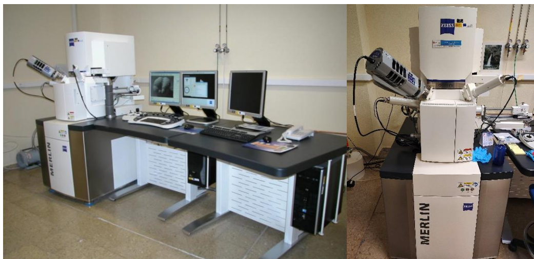
Figura 5.3.1. Microscopio electrónico de Barrido de la Universidad de Jaén (izquierda). Fuente: https://www.ujaen.es/servicios/scail/recursos/me03-microscopio-electronico-de-barrido-2 . Vista frontal del SEM (derecha). Fuente: Propia.
