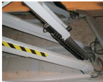
Figura 7.- Sistema de seguridad tipo sierra
