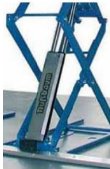
Figura 6.- Sistema seguridad de dos cilindros hidráulicos
