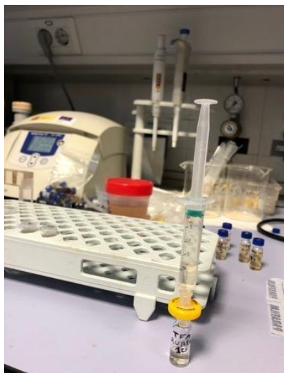
Figura 34. Filtración con membranas de Nylon de 0,45 \mu\text{m} para acondicionamiento de muestras para HPLC (elaboración propia).
