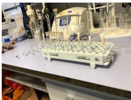
Figura 33. Acondicionamiento de muestras para HPLC, con resina de intercambio iónico (elaboración propia).
