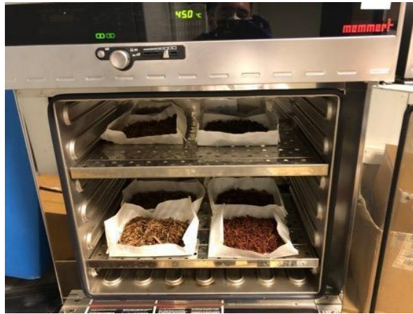
Figura 22. Secado de residuos sólidos (RSI) en estufa (marca Memmert) (elaboración propia).
