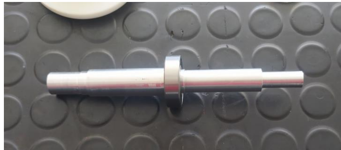
Ilustración 94: Eje principal mecanizado con un rodamiento intermedio de diámetro exterior igual a 32 milímetros
