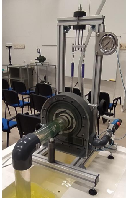
Ilustración 101: Turbina Kaplan sobre el banco de ensayo
