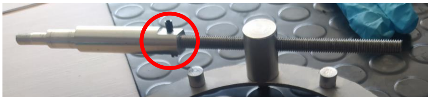
Ilustración 96: Eje distribuidor mecanizado
