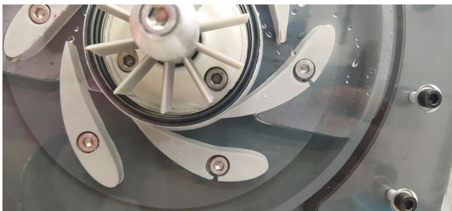
Gráfico 24: Álabes directrices rotos tras cerrar la válvula de entrada del caudal
