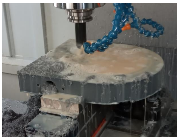
Ilustración 53: Mecanizado de la espiral logarítmica en el control numérico
