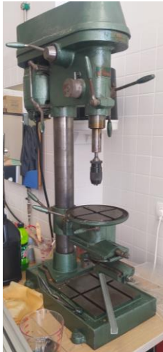
Ilustración 24: Taladro de columna de la EPS de Linares
