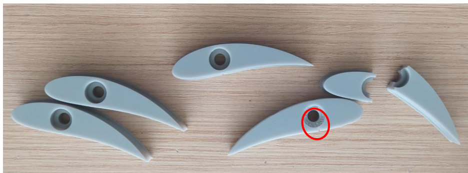
Ilustración 65: Álabes tras la rotura
