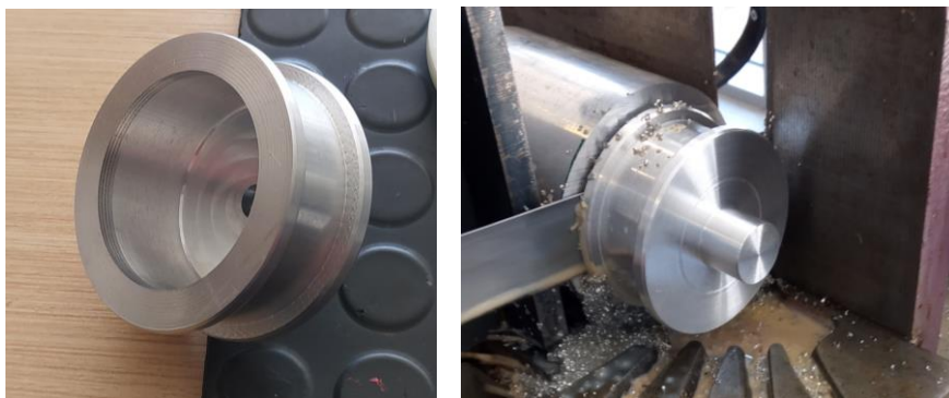
Ilustración 61: Mecanizado de la Polea de Freno
