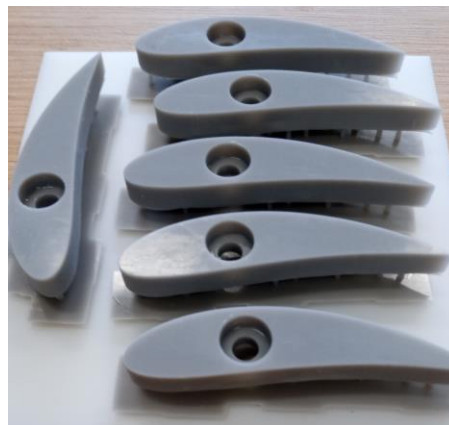
Ilustración 62: Álabes en el software ANYCUBIC PhotonWorkshop para ser impresos en 3D
