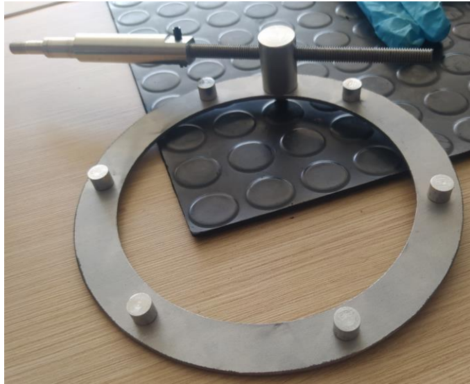
Ilustración 70: Anillo distribuidor y varilla roscada del sistema de giro
