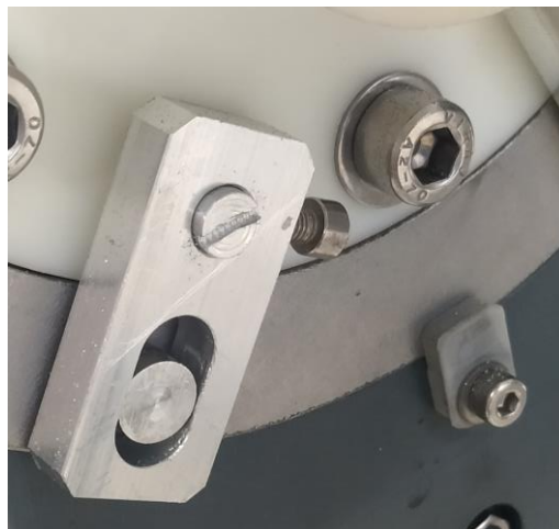
Ilustración 84: Ranura para poder girar los álabes sin tener que desarmar la carcasa de metacrilato
