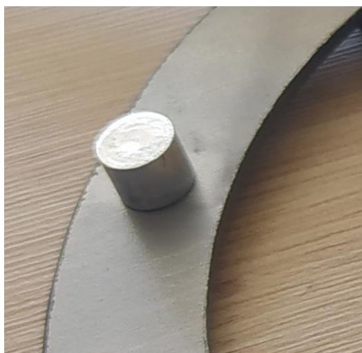
Ilustración 72: Casquillo colocado en el anillo distribuidor
