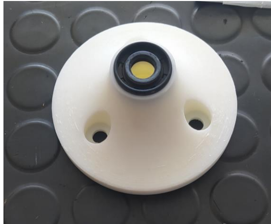
Ilustración 91: Nariz de PVC mecanizada con el retén que le corresponde
