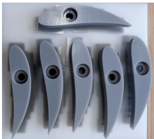
Ilustración 109: Álabes directrices fabricados originalmente
