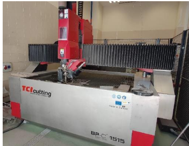
Ilustración 17: Máquina de corte por agua TCI-cutting BP-C 1515 de la EPS de Jaén
