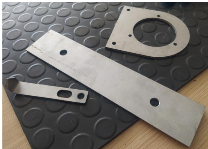
Ilustración 69: Chapa indicadora, chapa de base sin plegar y chapa de sujeción del manómetro
