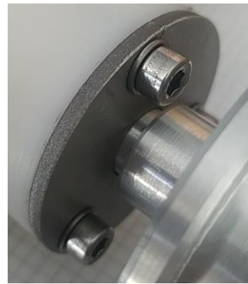
Ilustración 67: Chapa protectora del rodamiento trasero
