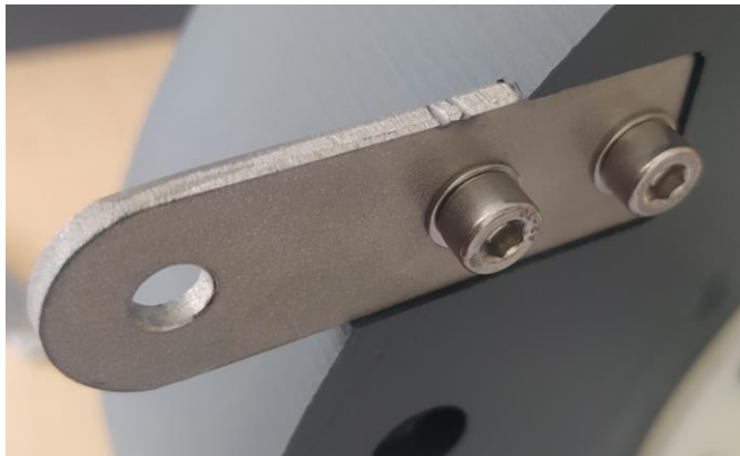
Ilustración 68: Chapa de unión entre la carcasa y el distribuidor
