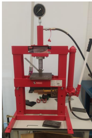
Ilustración 25: Prensa hidráulica con cilindro móvil cat83010ts
