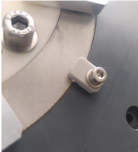
Ilustración 75: Tope del anillo distribuidor. Fabricado y unido a la carcasa
