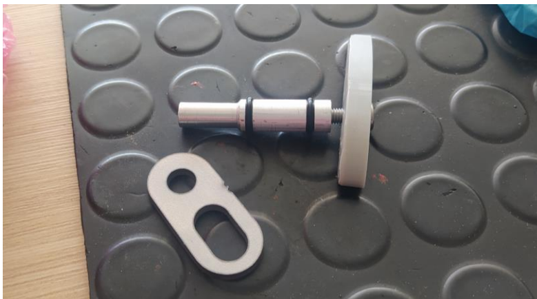
Ilustración 76: Álabes y chapa de unión entre el anillo distribuidor y el eje del álabes
