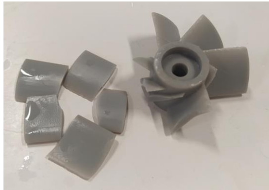
Ilustración 108: Hélice con aspas rotas por fatiga
