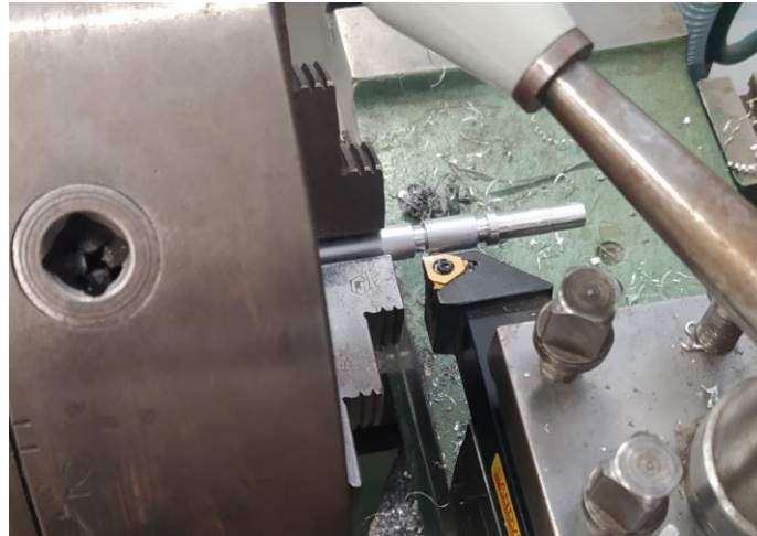
Ilustración 81: Eje nuevo realizado en el torno
