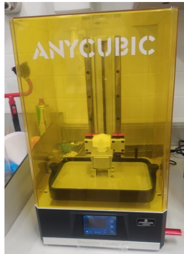
Ilustración 18: Impresora 3D para resina ANYCUBIC Photon Mono X
