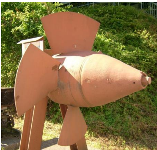
Ilustración 8: Turbina Kaplan de 1928
