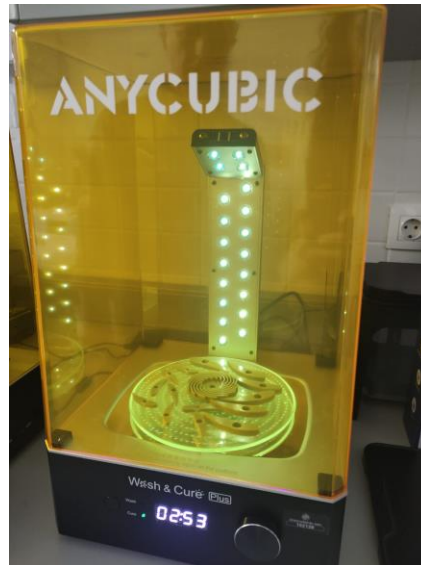
Ilustración 64: Proceso de curación de los álabes y otras piezas
