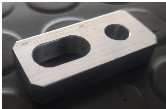
Ilustración 80: Nuevo diseño de la chapa distribuidora
