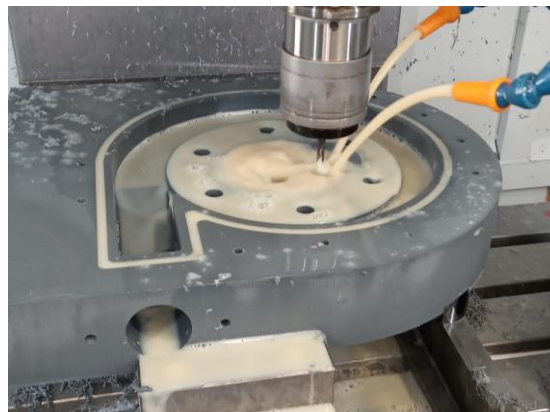
Ilustración 51: Mecanizado de los taladros de la carcasa mediante control numérico
