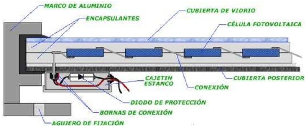
Figura 16. Elementos del módulo fotovoltaico. Fuente: [10]
