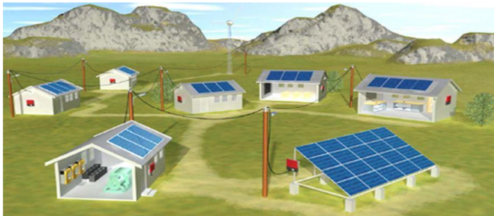
Figura 4. Ejemplo de una microrred basada únicamente en energía fotovoltaica. Fuente: [1]
