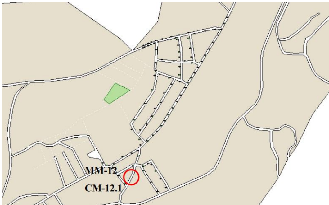
Ilustración 5.12.1.3. Módulo de medida 12.1 y luminarias dependientes.
