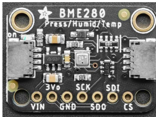
Ilustración 26. Sensor de temperatura, humedad y presión BME280
