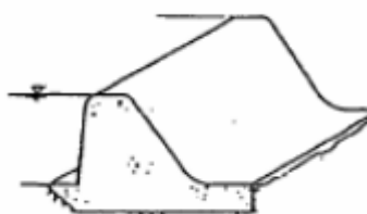
Ilustración 21: Azud de hormigón
