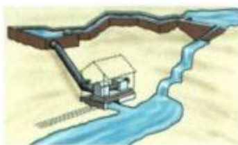
Ilustración 26: Canal de derivación tipo abierto
