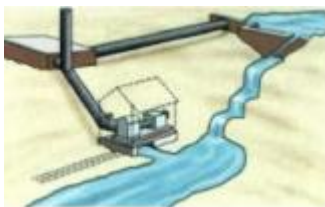
Ilustración 27: Canal de derivación tipo cerrado
