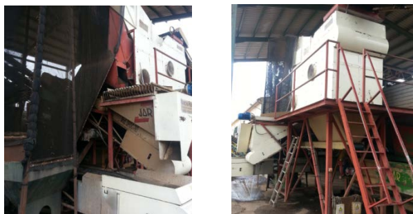
FIGURA 8: EQUIPO DE LIMPIEZA DE HOJAS, TALLOS Y PIEDRAS.
