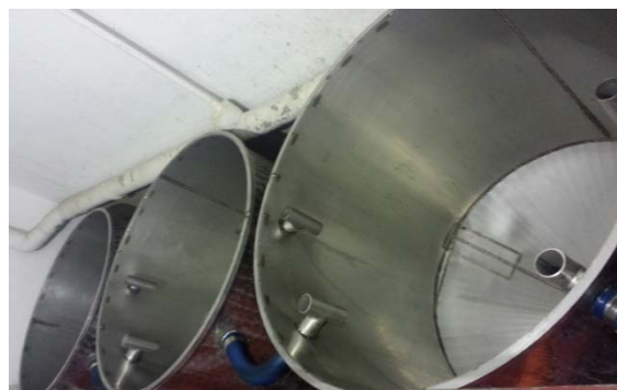
FIGURA 19: DETALLE TOLVAS DE DECANTACIÓN.
