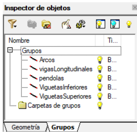
Figura 5.9- Grupos de barras que conforman la pasarela
