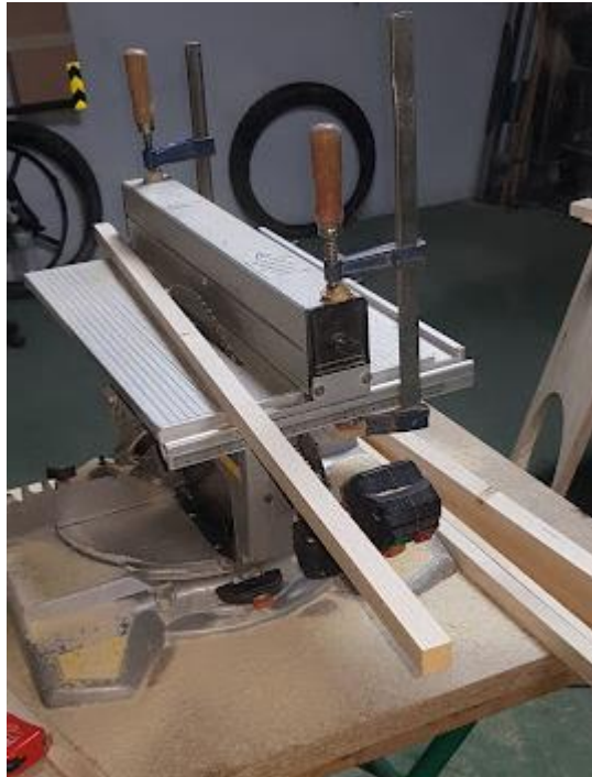
Ilustración 8.33: Corte de listones mediante sierra ingletadora. Fuente: Elaboración propia
