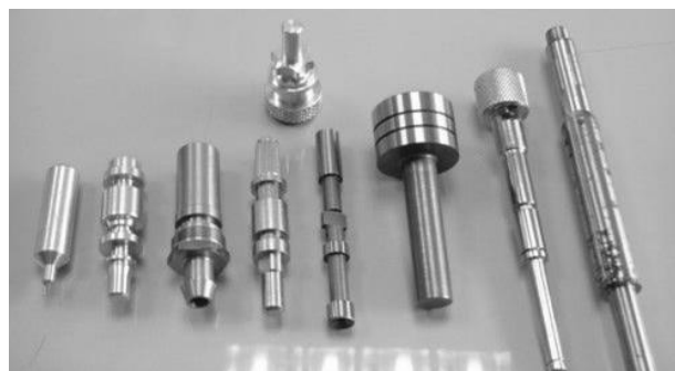
Ilustración 6.3: Ejemplo de formas de piezas a toronar. Fuente: Torno. www.areatecnologia.com
