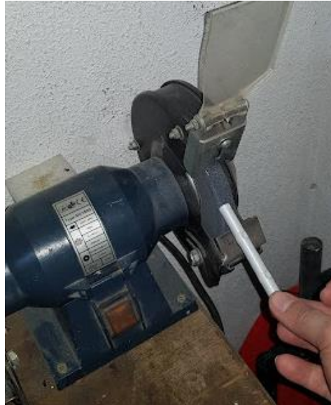
Ilustración 8.23: Amolado de eje de nuestro torno. Fuente: Elaboración propia
