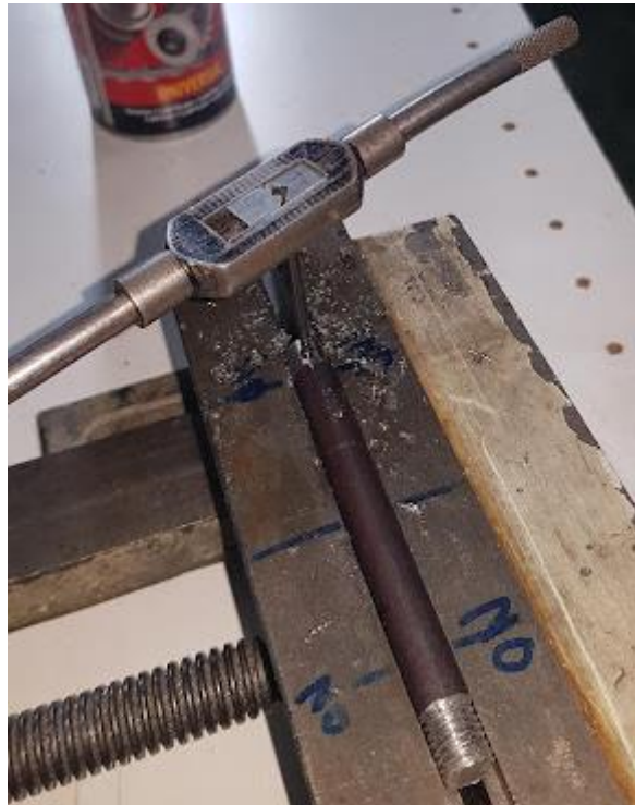
Ilustración 8.21: Roscado de eje de nuestro torno. Fuente: Elaboración propia
