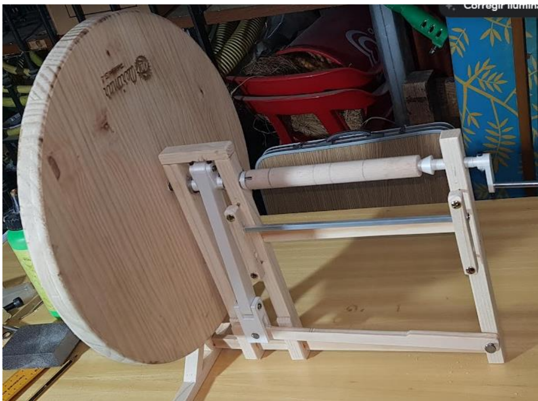
Ilustración 8.62: Imagen de nuestro torno acabado de montar. Fuente: Elaboración propia
