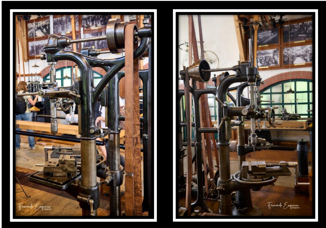
Ilustración 6.20 y 6.21: Ejemplo de Taladro de columna Estarta y Ecenarro del museo de la máquina herramienta en Elgoibar, Guipúzcoa. Fuente: Museo de la máquina herramienta. www.ezquerro.eu
