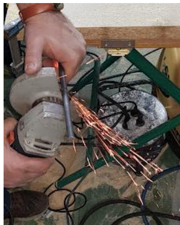
Ilustración 8.18: Corte mediante radial del eje. Fuente: Elaboración propia
