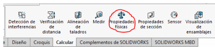
Ilustración 7.35: Imagen detallada de como abrir la opción Propiedades físicas en SolidWorks. Fuente: Elaboración propia
