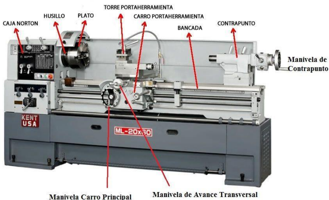
Ilustración 6.4: Representación gráfica de las partes del Torno. Fuente: Torno. www.areatecnologia.com
