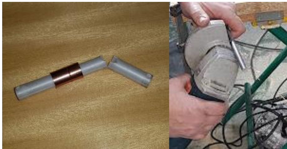
Ilustración 8.36: Rotura del eje de PLA y construcción del nuevo eje en acero. Fuente: Elaboración propia
