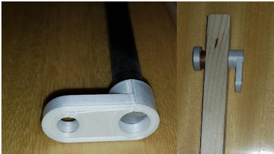
Ilustración 8.40: Prueba del eje con el cigüeñal y el cabezal con el listón. Fuente: Elaboración propia
