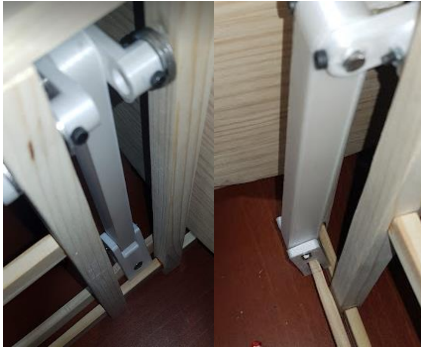
Ilustración 8.598: Imagen del roce del acople con el listón inferior. Fuente: Elaboración propia
