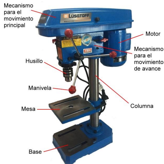
Ilustración 6.16: Componentes principales de un taladro. Fuente: ¿Qué es un taladro de banco?. www.demaquinasyherramientas.com
