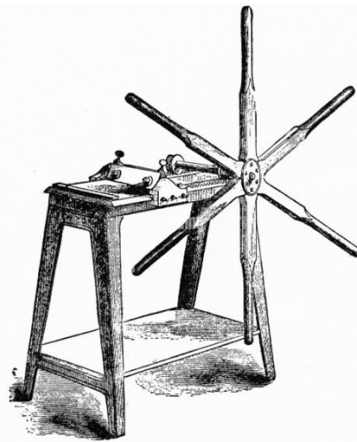
Ilustración 6.34: Primera máquina de cepillar metales (1751). Fuente: Grabado de una máquina de alisado manual. www.alamy.es
