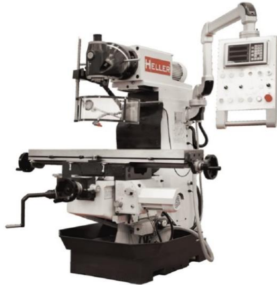
Ilustración 6.24: Ejemplo de fresadora horizontal universal marca Heller. Fuente: ¿Que es una fresadora universal?. www.hellermquinaria.com
