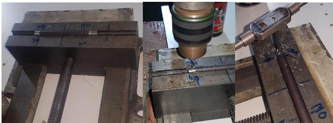
Ilustración 8.44: Taladrado y realización de roscado en eje. Fuente: Elaboración propia
