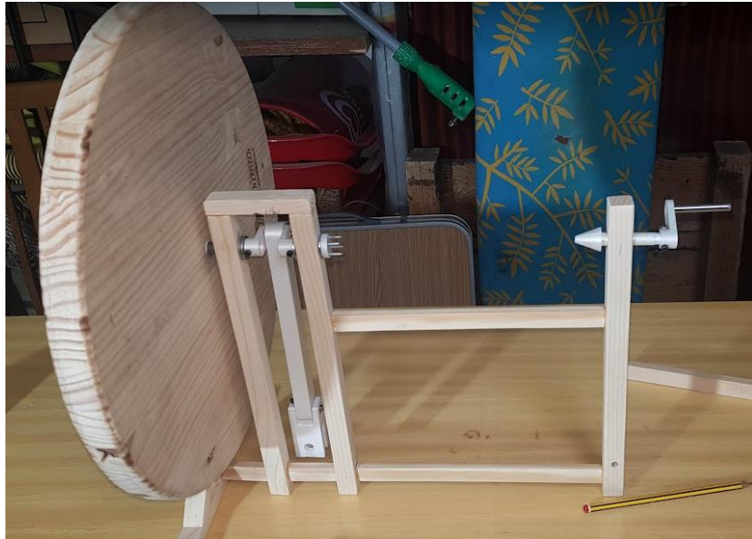
Ilustración 8.54: Montaje del contrapunto roscado. Fuente: Elaboración propia
