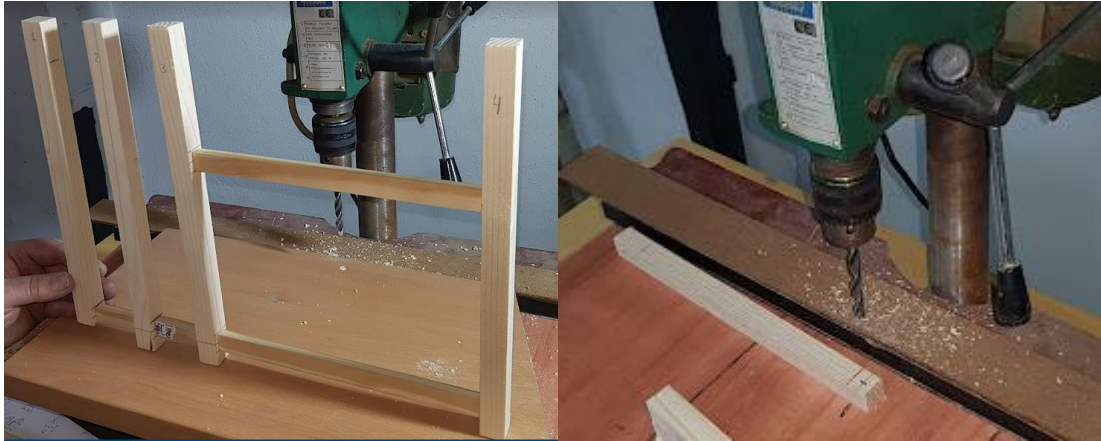
Ilustración 8.35: Taladrado de los listones. Fuente: Elaboración propia
