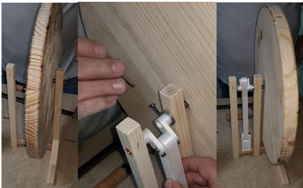
Ilustración 8.52: Montaje del cigüeñal y rueda en la estructura del torno. Fuente: Elaboración propia
