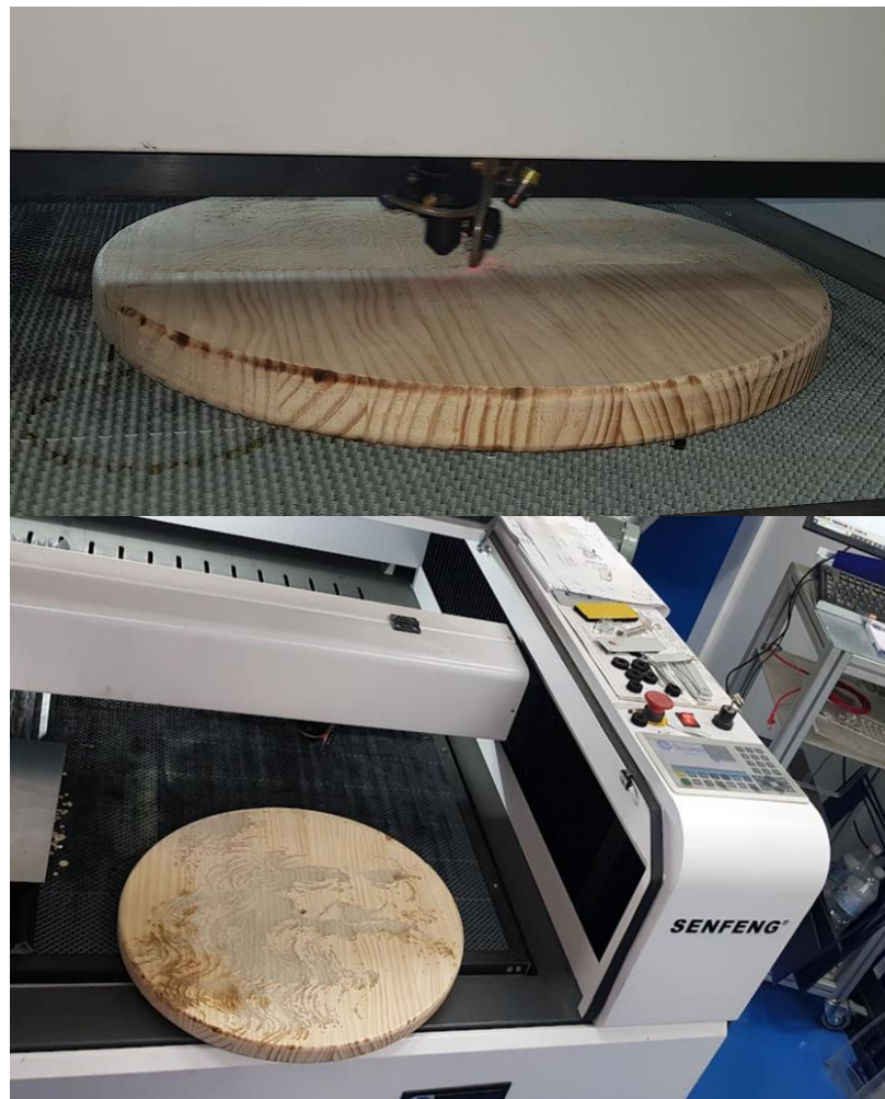
Ilustración 8.26: Grabado de cara de Leonardo Da Vinci en la rueda de nuestro torno mediante máquina de láser. Fuente: Elaboración propia
