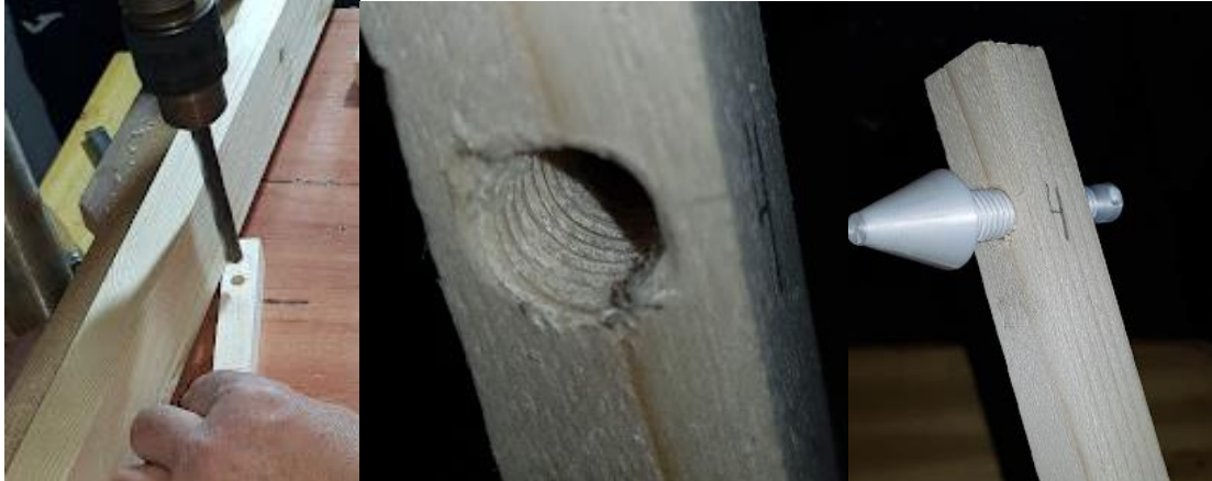
Ilustración 8.37: Roscado del listón del contrapunto. Fuente: Elaboración propia
