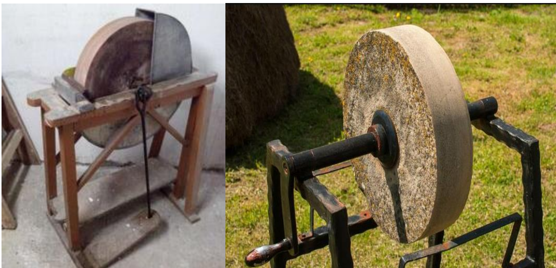
Ilustración 6.38 y 6.39: Ejemplo de piedras giratorias utilizadas para afilar a mano accionadas con el pie o con manivela. Fuente: Rueda manual de piedra de afilar antigua. www.alamy.es
