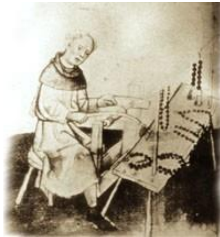
Ilustración 5.1: Grabado de torno accionado por arco (1435). Fuente: Evolución técnica de la máquina-herramienta. Reseña histórica. https://www.interempresas.net/ .
