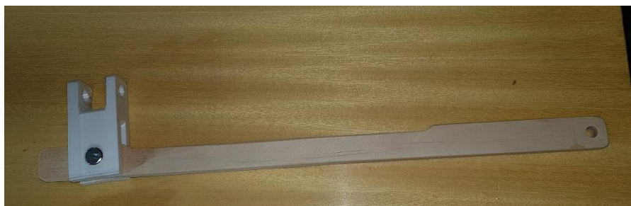
Ilustración 8.58: Pedal unido al acople mediante pasador. Fuente: Elaboración propia
