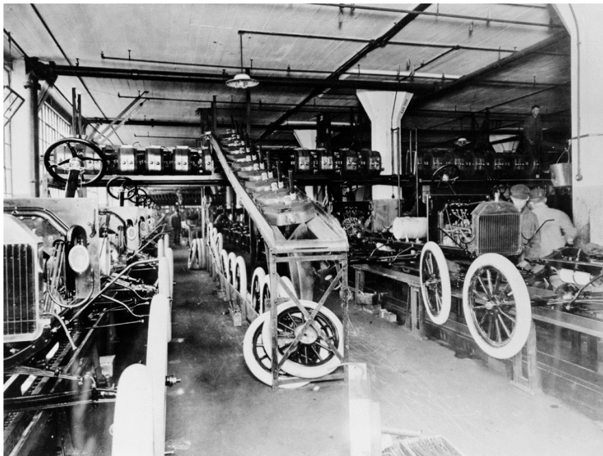
Ilustración 5.11: Primer transportador en cadena en Highland Park. Fuente: Así nació la producción en cadena. Highland Park. www.iconroad.es
