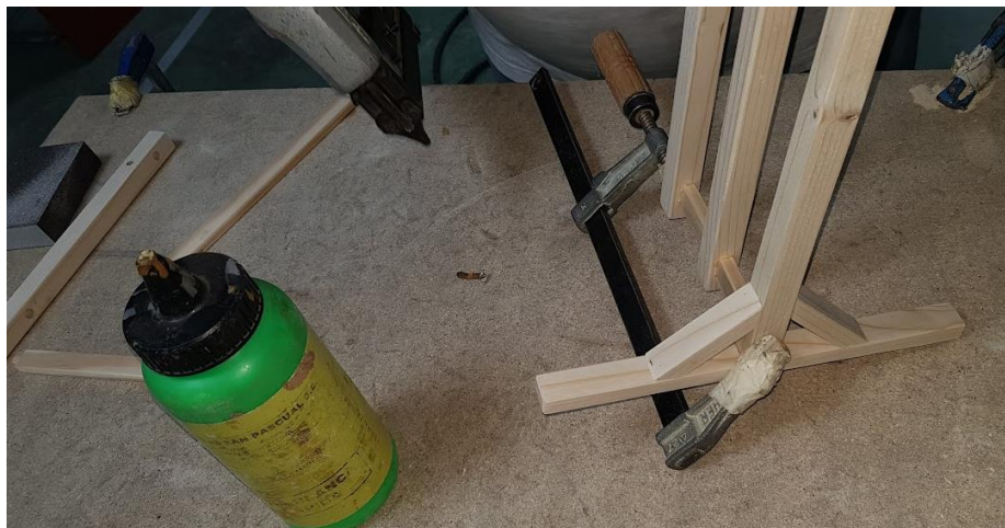
Ilustración 8.49: Encolado y apuntalado de la estructura. Fuente: Elaboración propia
