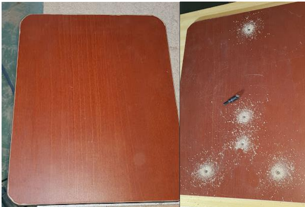
Ilustración 8.64: Taladrado de base donde irá fijado nuestro torno. Fuente: Elaboración propia
