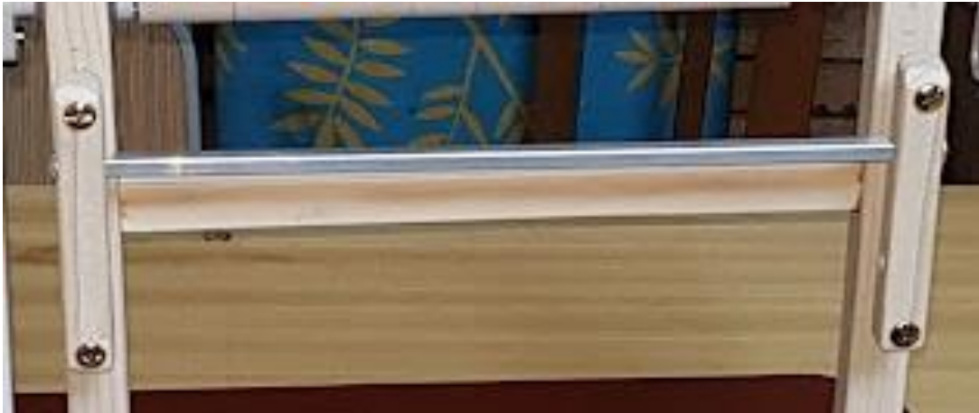
Ilustración 8.61: Montaje Barra de aluminio soporte herramienta. Fuente: Elaboración propia
