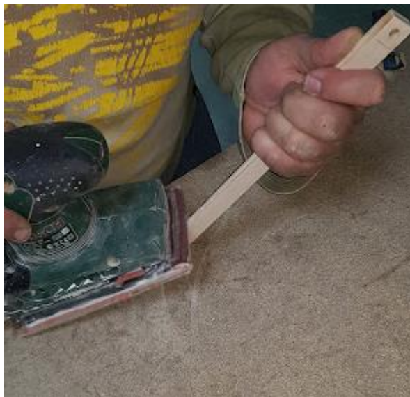
Ilustración 8.22: Lijado de pedal de nuestro torno. Fuente: Elaboración propia
