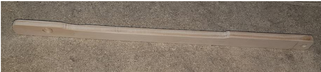
Ilustración 8.57: Pedal cepillado y terminado. Fuente: Elaboración propia
