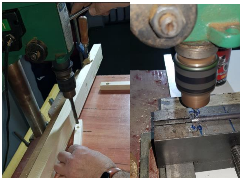
Ilustración 8.17: Taladrado de piezas de nuestro torno. Fuente: Elaboración propia
