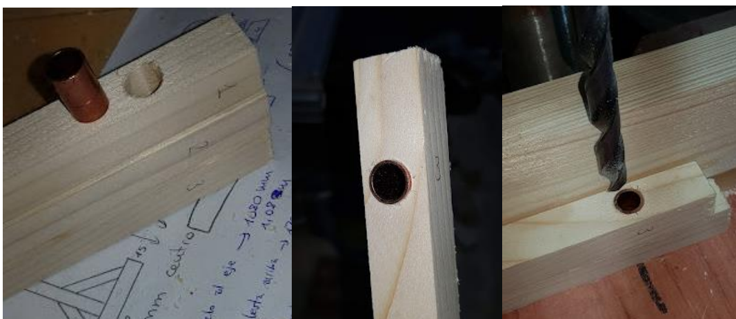
Ilustración 8.38: Introducción y retaladrado de los cojinetes en los listones. Fuente: Elaboración propia
