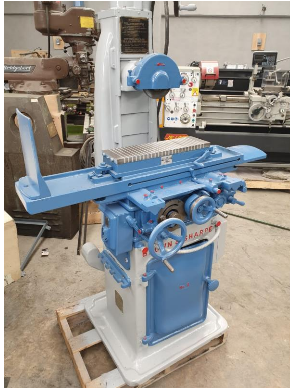
Ilustración 6.40: Ejemplo de rectificadora universal Brown & Sharpe. Fuente: Rectificadora Brown & Sharpe. www.comisavee.com
