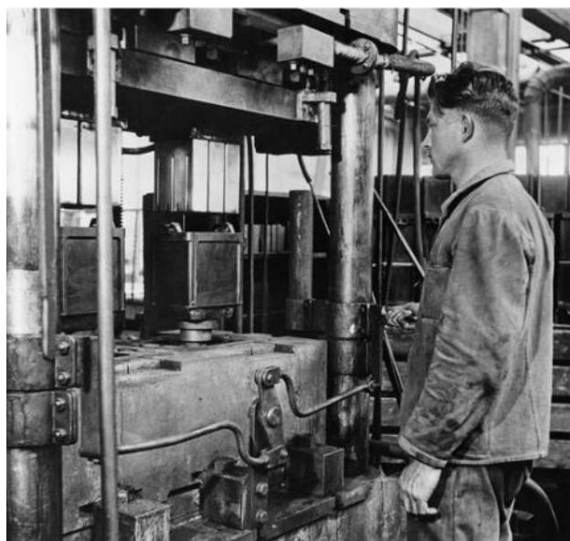
Ilustración 6.46: Trabajadores de fábrica en la planta de Bosch: Las cajas de caucho duro para baterías de arranque se presionan en prensas hidráulicas pesadas. Fuente: Prensas hidráulicas . www.alamy.es
