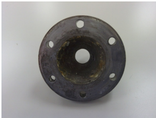
Figura 4.42. Vista inferior o interna de la tobera.
