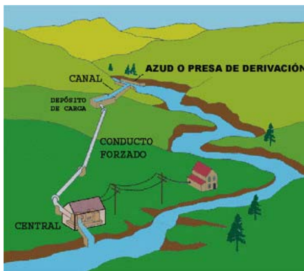
Figura 2.1. Esquema de una central de agua fluente. Fuente: http://tecnologia-cardones.wikispaces.com/4
