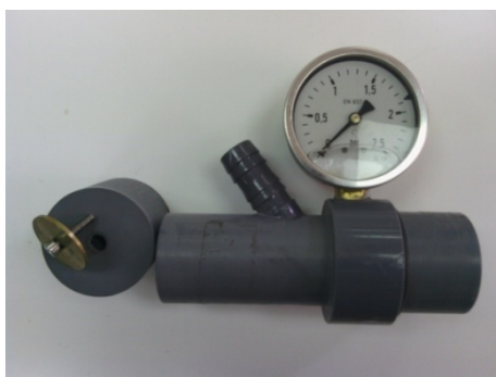
Figura 2.10. Cuerpo, manómetro y mando regulador del inyector de la turbina.
