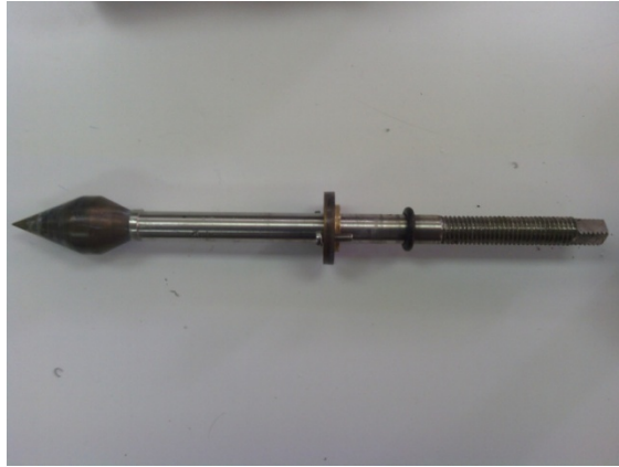
Figura 2.7. En la figura la aguja que utiliza la turbina de nuestro banco de ensayos, casi idéntica a las empleadas en las instalaciones industriales.
