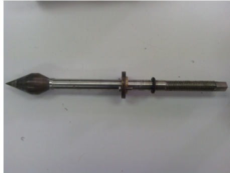
Figura 4.47. Vista de la rosca de la base de la aguja.
