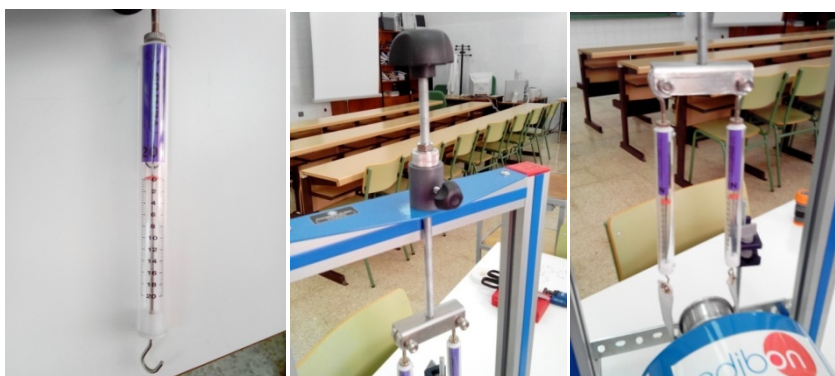
Figura 2.11. Dinamómetro y vista de su montaje en el freno de prony.
