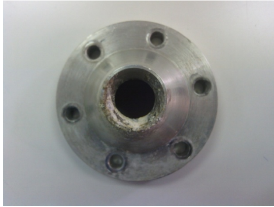
Figura 4.41. Vista superior de la tobera de salida.
