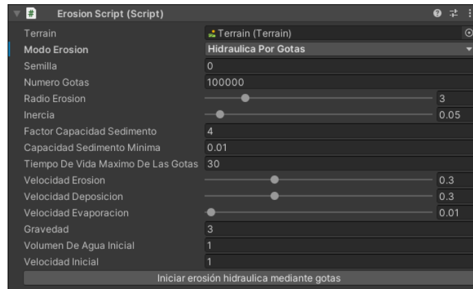
Ilustración 6.14 – Inspector en Erosion Script para Hidráulica por gotas
