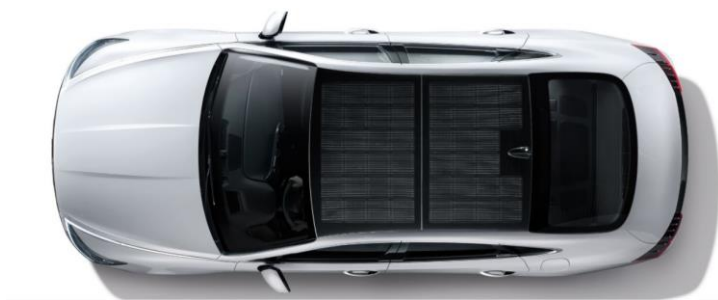
Fig. 89 Paneles en el techo del Sonata Hybrid (Hyundai Motor Group, 2019)
