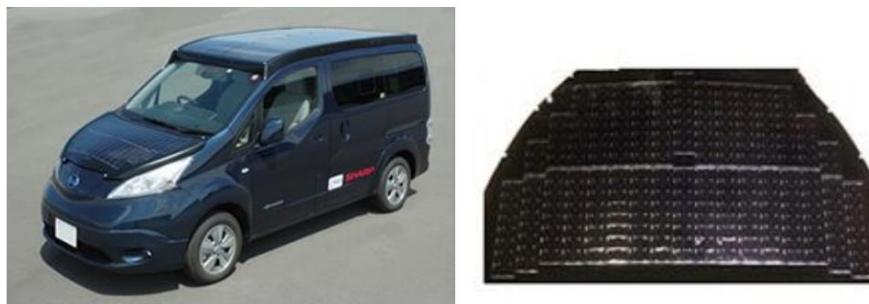
Fig. 96 Prototipos de VIPV usando células solares multiunión III-V en el Nissan e-NV200
