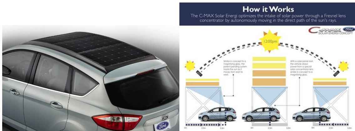
Fig. 61 El Ford C-MAX Solar Energi Concept y explicación del funcionamiento de su cubierta. (Ibañez, 2017)
