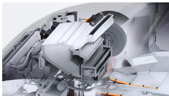
Fig. 75 Sistema de gestión térmico del Lightyear 0 (Lightyear, 2022)
