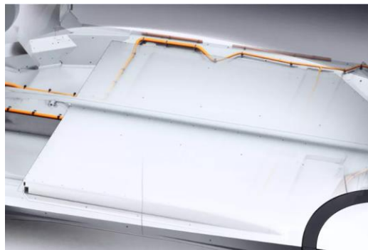
Fig. 74 Sistema de baterías. (Lightyear, 2022)
