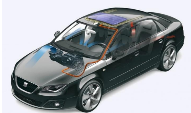
Fig. 55 Sistema fotovoltaico cuyo uso es de climatización interior. (Ibañez, 2017)
