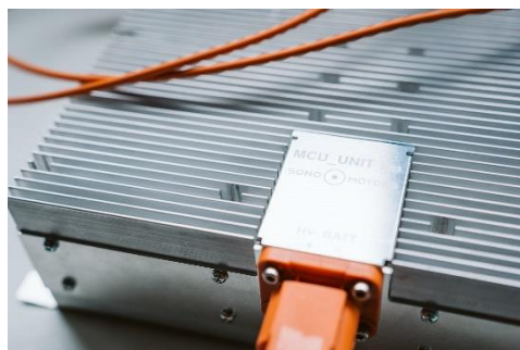
Fig. 9 Unidad de MMPT del Sono Sion. (Sono Motors, 2021)
