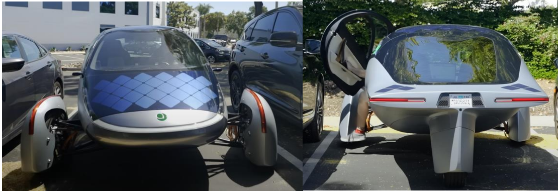
Fig. 66 Aptera donde se puede apreciar las células del capo y de la parte trasera. (Aptera, 2022)
