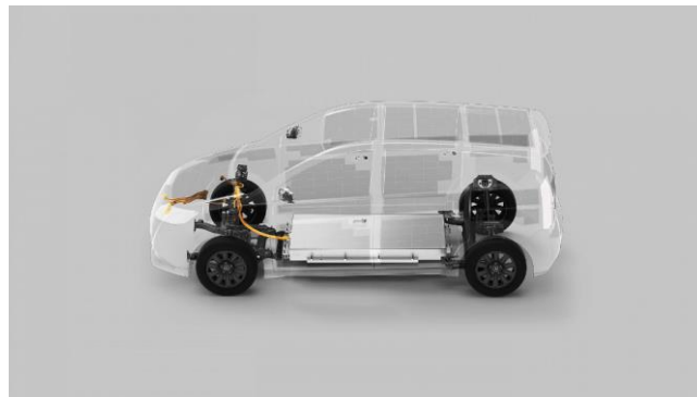
Fig. 82 Sistema de refrigeración del Sion. (Sono Motors, 2022)
