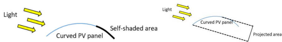
Fig. 36 Autosombreado del panel fotovoltaico curvo. (Araki, et al., 2021)
