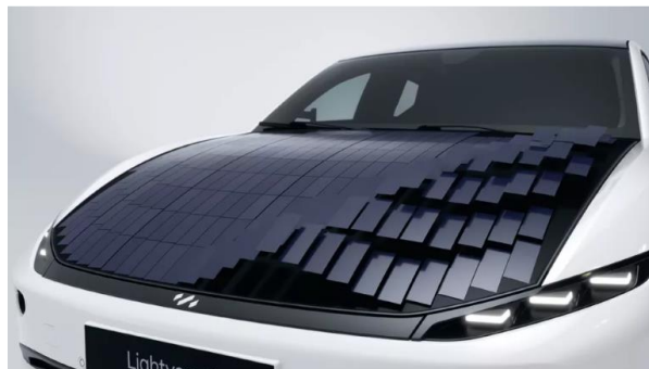
Fig. 77 Células sobre el capó (Lightyear, 2022)
