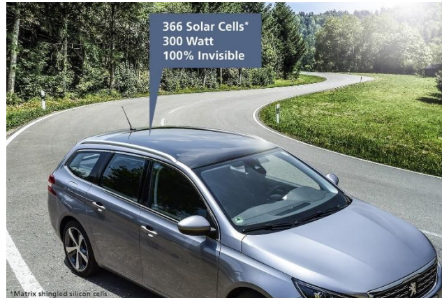
Fig. 6 Imagen de un VIPV que cuenta con 300 Watios de potencia en el techo. (Fraunhofer Institute for Solar Energy Systems, 2022)
