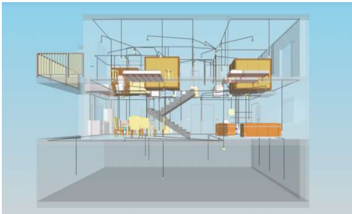
Figura 2.8. Instalación eléctrica con CYPELEC Distribution (Frontal)
