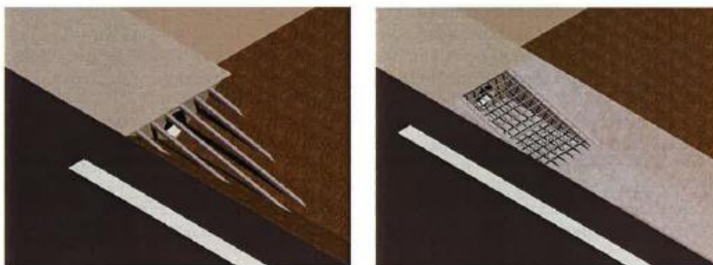
Figura 4: Esquemas de dispositivos para la protección de pasos salvacunetas.
