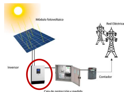
Figura 53.- Posición del inversor dentro de la planta solar fotovoltaica.
