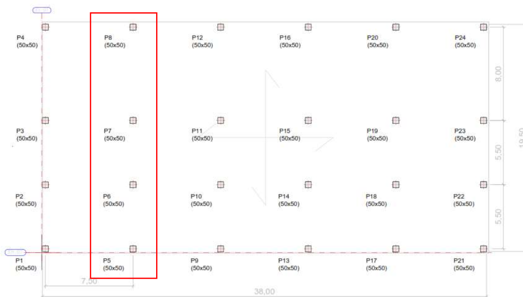
Figura 11: Vista en planta del Pórtico 6
