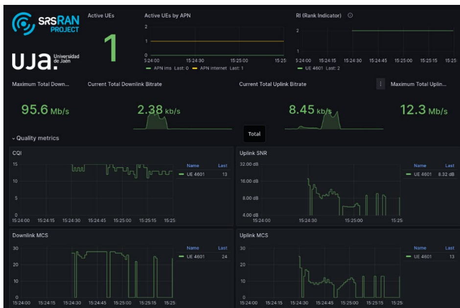
Figura 50: Panel de Grafana donde se muestran las métricas del gNodeB relacionadas con el número de UE, uso de MIMO e índices de calidad de las conexiones descendente y ascendente
