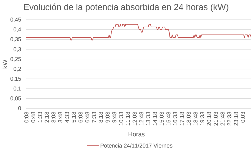
Gráfica 21: Evolución de la potencia absorbida en 24 horas en kW por el cuadro de energía reactiva de los transformadores.
