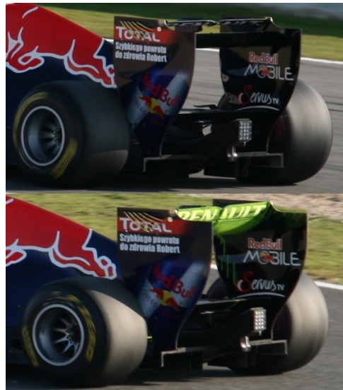
Figura 2.19: Sistema DRS en monoplaza de Red Bull Racing (2011).
