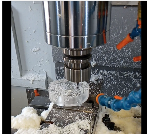
Figura 5.54 Ranura para la junta tórica en Fusion360 (izda) y durante su mecanizado (dcha)
