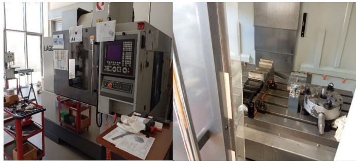
Figura 5.6 Máquina de mecanizado de 3 ejes modelo Lagun L650, mediante control numérico con una mordaza cilíndrica para mecanizar piezas de revolución y otra plana para piezas con caras planas.
