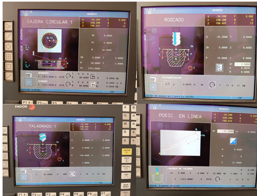
Figura 5.22 Ciclo fijos programados en el CNC. Se pueden programar desde el mismo interfaz de la máquina.
