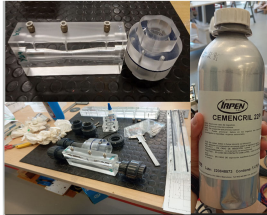
Figura 5.57 Resultados del Venturi tras su fabricación, a los cuales se les ha incluido dos empalmes en los extremos para su despiece y mantenimiento (izda). Pegamento especial para metacrilato utilizado en el proceso (dcha).
