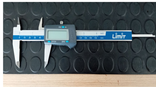
Figura 5.16 Partes de un pie de rey, extraída de la fuente FM Formación [3] (izda). Pie de rey digital disponible en el taller de Máquinas y Herramientas de la EPSL (dcha).
