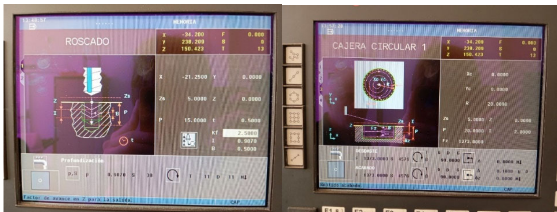
Figura 5.52 Ciclos fijos de roscado y de cajeado programados previamente en la interfaz de la propia máquina.
