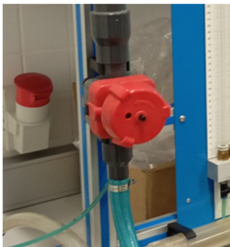
Figura 5.27 Tubería de desagüe del equipo de Edibon formado por una válvula de membrana, una reducción 40-32 y otra de 32-22 para acoplar la espiga para la manguera.
