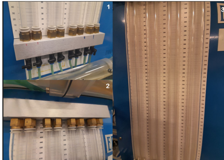
Figura 5.28 1.Colector inferior 2.Colector superior 3.Tubos piezométricos con sus reglas milimetradas. Todas las partes están conectadas mediante conexiones de latón.
