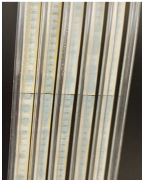
Figura 5.62 Reglas milimetradas de polietileno grabadas con láser de CO 2 . Justo detrás de los tubos piezométricos
