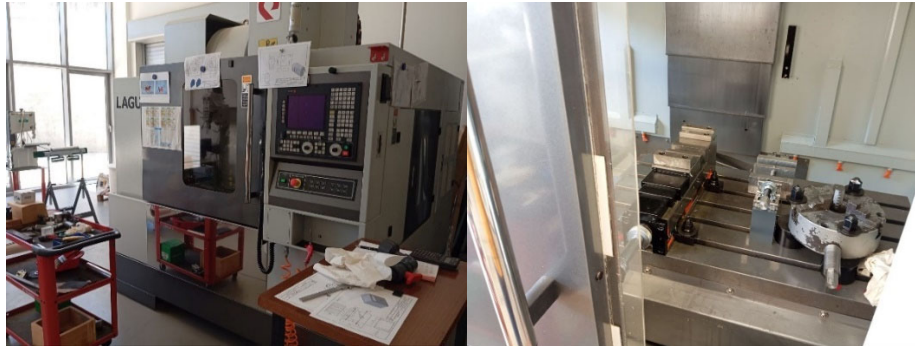
Figura 5.48 Máquina de mecanizado de 3 ejes, mediante control numérico con una mordaza cilíndrica para mecanizar piezas de revolución y otra plana para piezas cuadradas o con caras.
