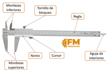
Figura 5.16 Partes de un pie de rey, extraída de la fuente FM Formación [3] (izda). Pie de rey digital disponible en el taller de Máquinas y Herramientas de la EPSL (dcha).
