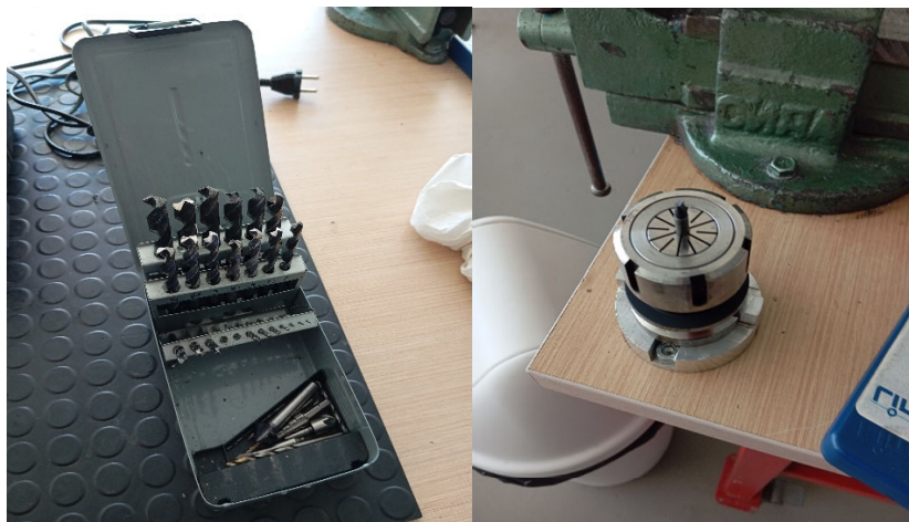
Figura 5.7 Distintos tipos de brocas y fresas disponibles en el taller de Máquinas y Herramientas de la EPSL (izda) junto con el portaherramientas (dcha).
