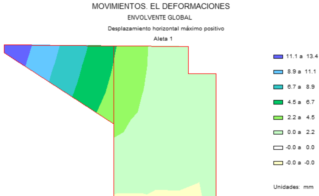
Figura 13.25.Desplazamiento horizontal máximo positivo. Aleta 1.
