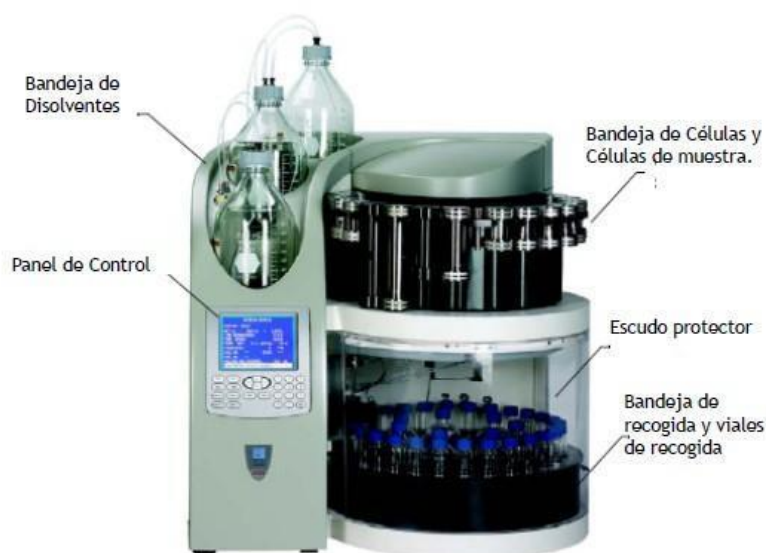
Figura 14. PF07-Sistema de extracción con líquidos presurizados (UJA, (s.f.))
