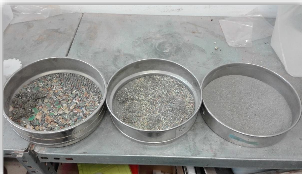
Figura 6 - Fracciones resultantes tras el tamizado, [Elaboración propia].
