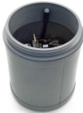
Figura 3.6 Situación sensor magnético dentro del encapsulado.
