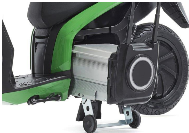
Ilustración 39. Motocicleta extrayendo la batería (silence.eco)
