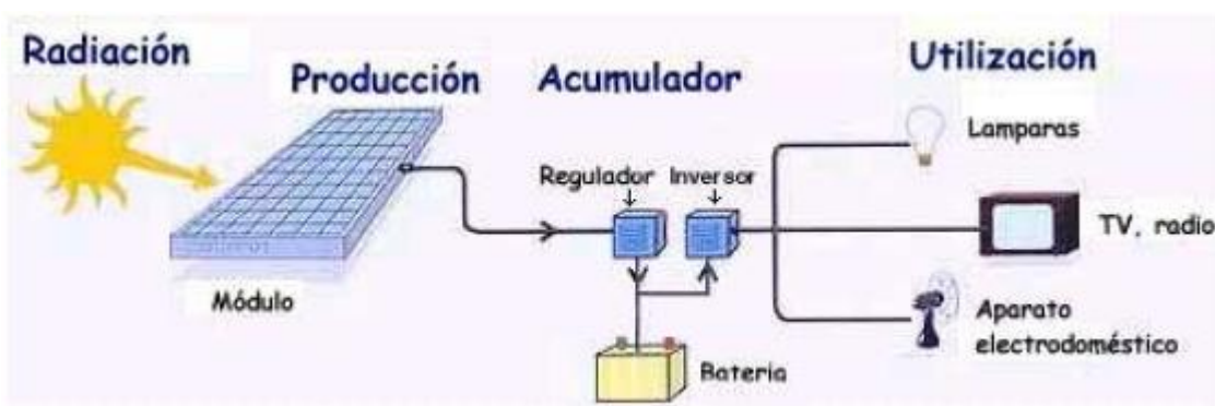
(Figura 3.16. Instalación con inversor a 230V)
