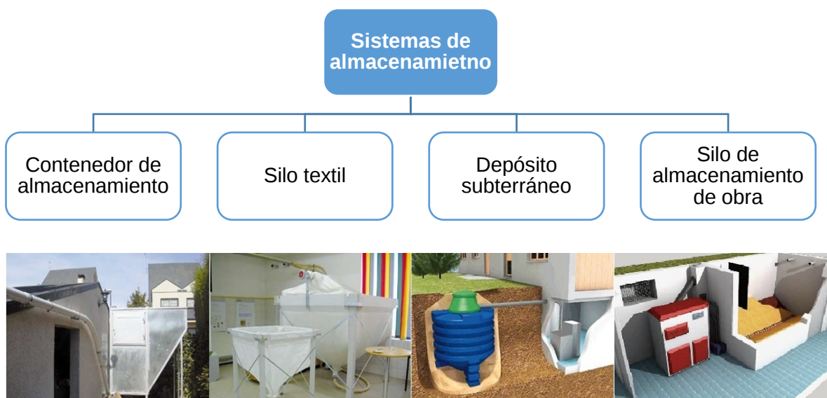
Figura 3.8 Sistemas de almacenamiento de biomasa. [Elaboración propia]
