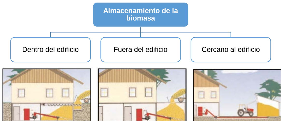
Figura 3.7 Distintos tipos de emplazamiento para el almacenaje de la biomasa. [Elaboración propia]
