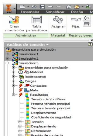
Ilustración 13. Resultados del análisis estático en Autodesk Inventor Professional.
