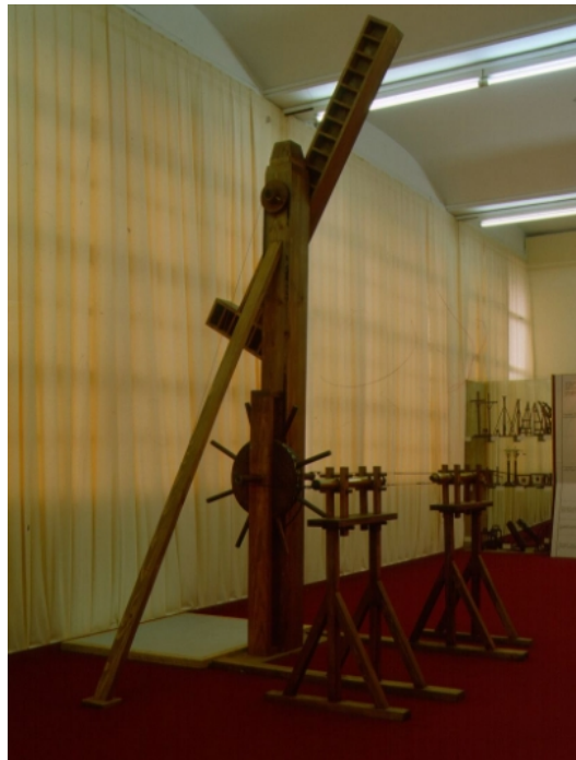
Ilustración 3. Telégrafo óptico de Agustín de Betancourt y Molina [5].
