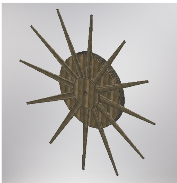
Ilustración 26. Perspectiva axonométrica de la polea principal.
