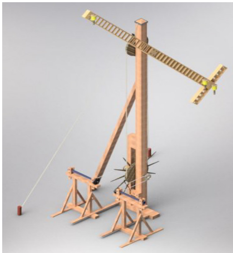
Ilustración 44. Perspectiva axonométrica del ensamblaje completo del telégrafo óptico.
