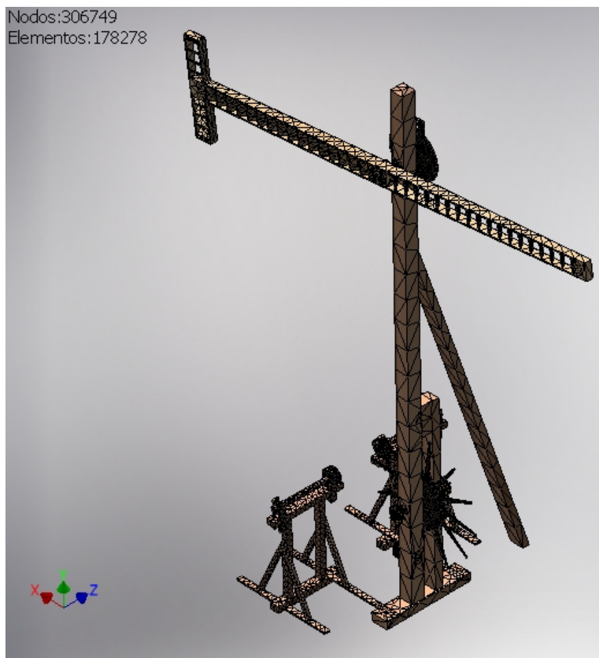
Ilustración 53. Mallado automático generado por Autodesk Inventor Professional.
