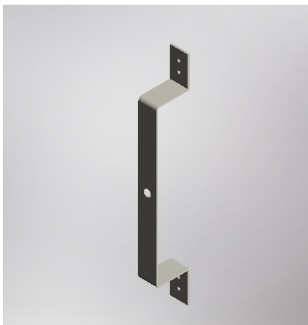
Ilustración 34. Perspectiva axonométrica de la chapa polea superior.
