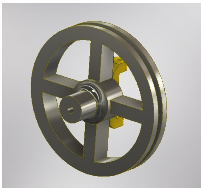
Ilustración 30. Perspectiva axonométrica de la pieza enganche a polea.
