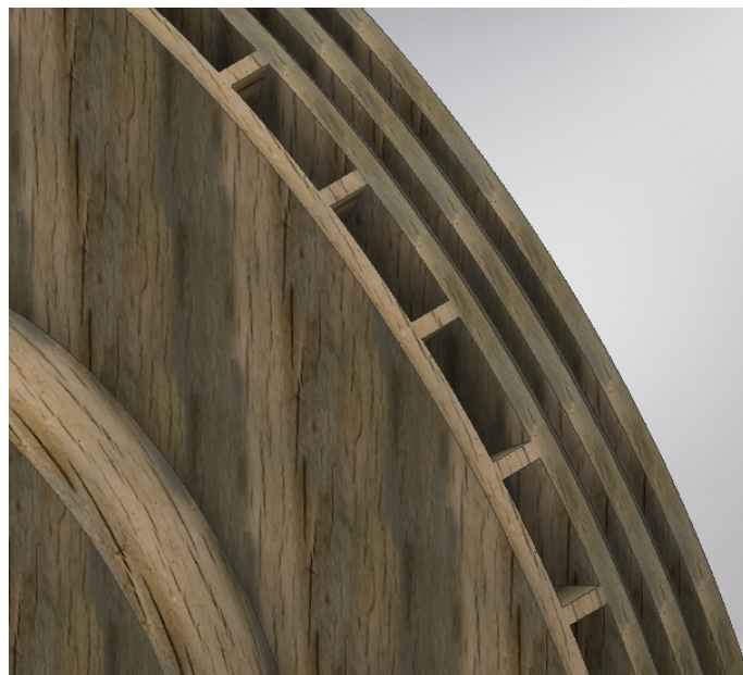
Ilustración 27. Detalle de ranuras de la polea principal.
