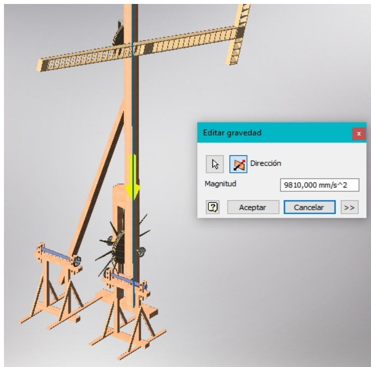
Ilustración 50. Aplicación de la fuerza de la gravedad en el telégrafo óptico.
