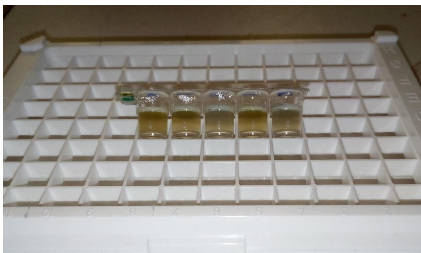
Figura 21. Resultado negativo del test para sustancias inhibidoras en muestras de leche cruda.
