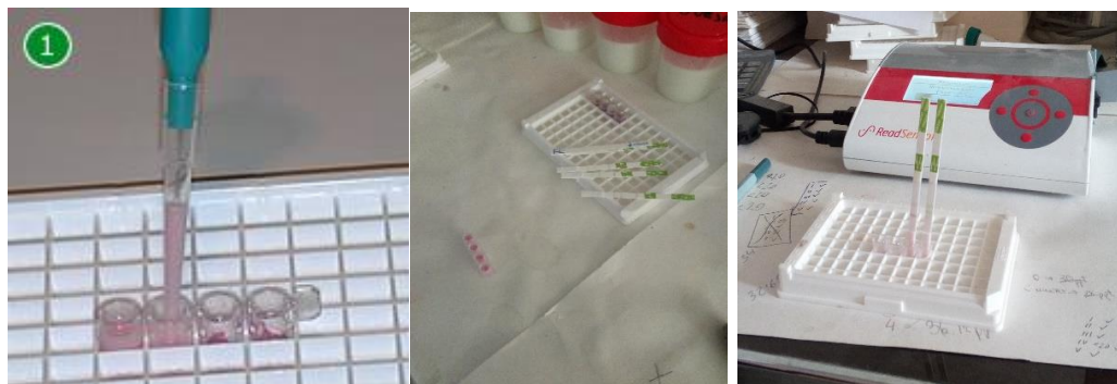
Figura 9. Procedimiento del test Aflasensor y cuantificación en máquina de detección LIMELE
