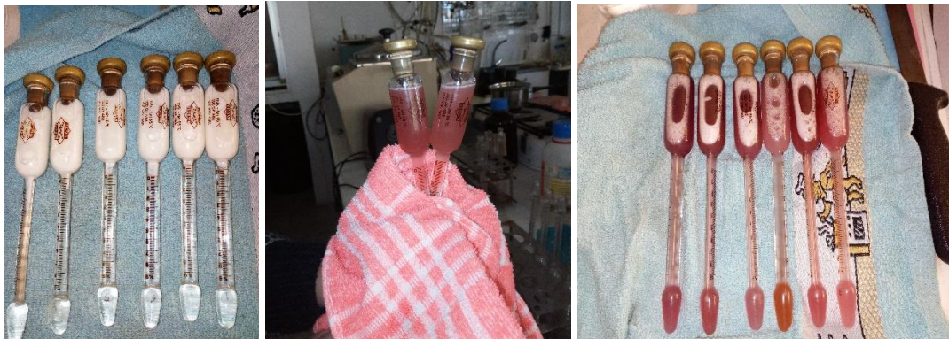
Figura 16. Aspecto de los butirómetros tras ser agitados.
