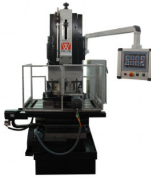
Imagen 11: Mortajadora, fuente: www.hellermaquinaria.com
