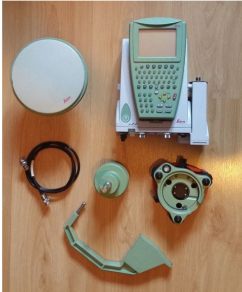
Figura 7. Equipo GNSS fijo
