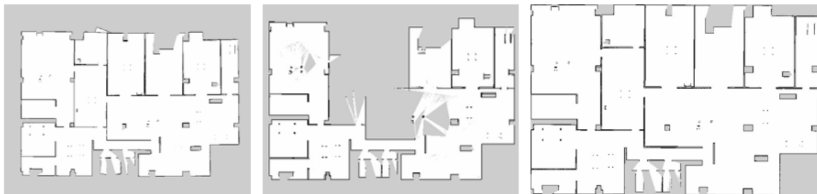
Figura 4.4. Mapas simulados con a) Gmapping b) Hector mapping c) Karto mapping .
