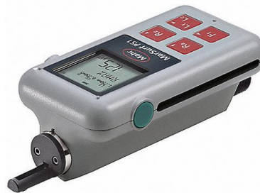
Ilustración 1.3 – Equipo portátil para medición de acabado superficial
