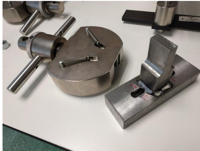
Figura 48. Mordaza (izquierda) y base o soporte (derecha) de acero para ensayos.
