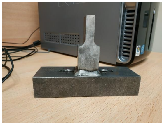
Figura 60. Base o soporte de acero para ensayos de la fase II.
