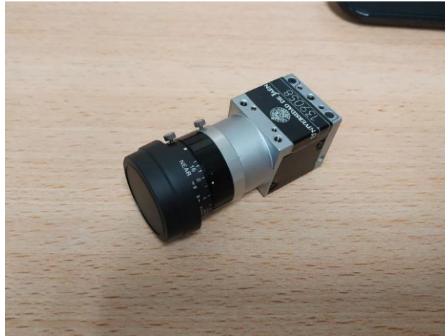
Figura 27. Cámara Basler usada para los ensayos de DIC.
