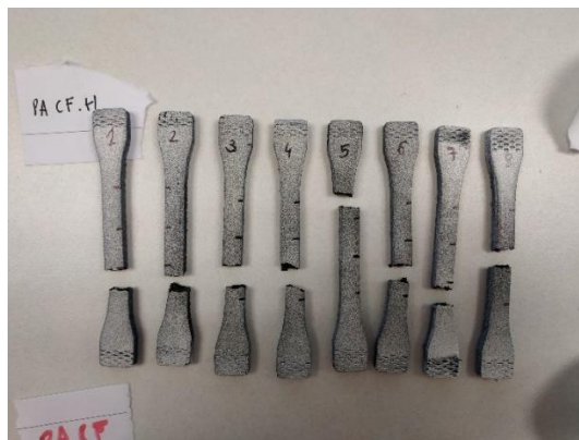
Figura 57. Probetas tipo hueso una vez ensayadas.
