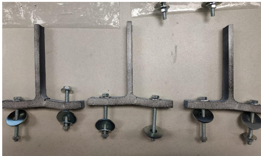
Figura 114. Modos de rotura de las T-stub de PET CF de 15 mm de ancho.
