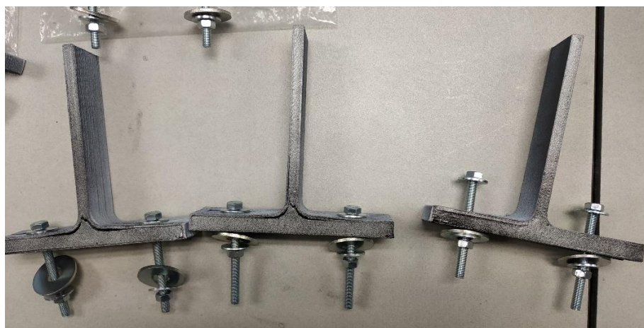
Figura 112. Modos de rotura de las T-stub de PA CF de 25 mm de ancho.
