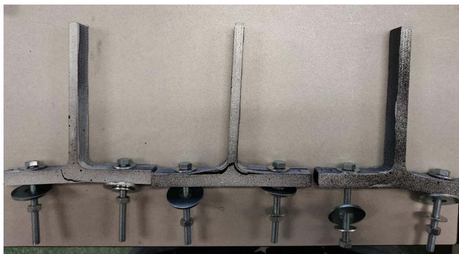
Figura 111. Modos de rotura de las T-stub de PA CF de 15 mm de ancho.
