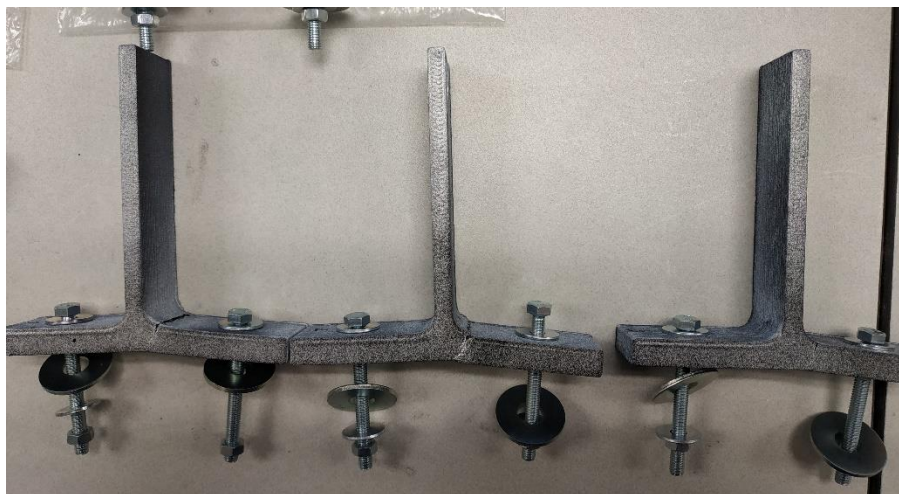
Figura 116. Modos de rotura de las T-stub de PET CF de 25 mm de ancho.
