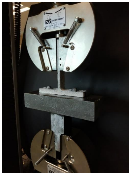
Figura 63. Colocación de la probeta T-stub en la máquina para realizar el ensayo.
