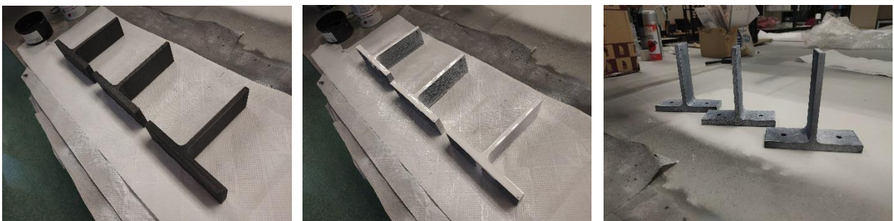
Figura 62. Proceso de pintar las probetas para la realización del ensayo.
