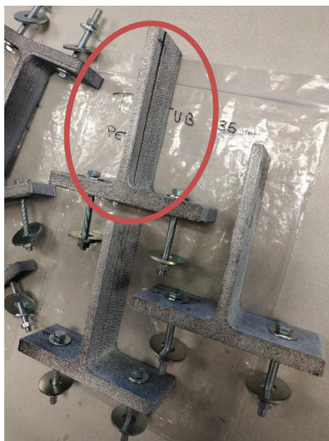
Figura 117. Modos de rotura de las T-stub de PET CF de 35 mm de ancho.
