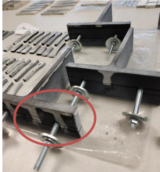
Figura 113. Modos de rotura de las T-stub de PA CF de 35 mm de ancho.
