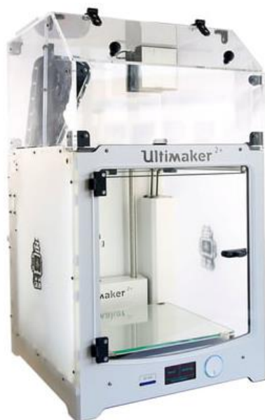
Figura 32. Impresora 3D con cubierta para controlar la temperatura. [21]
