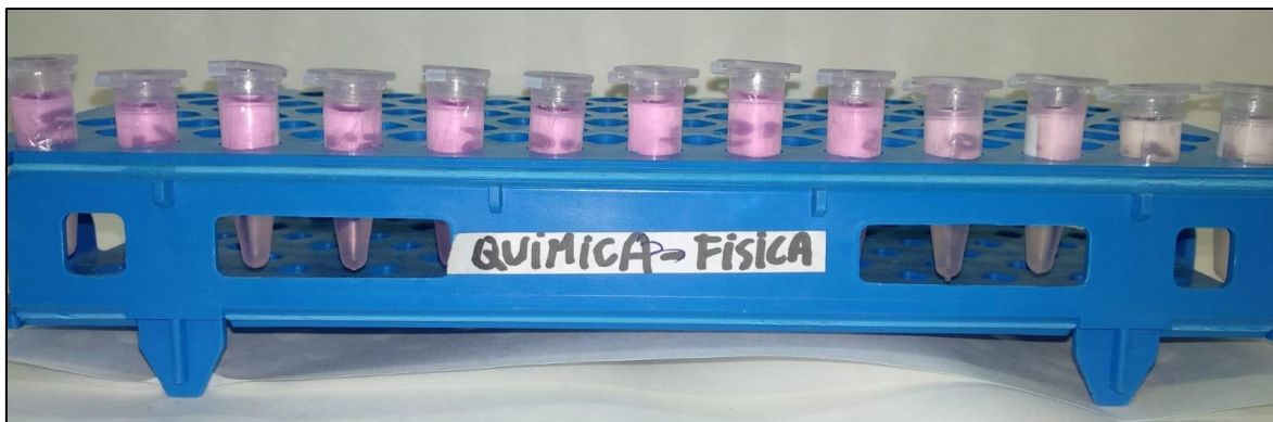
Imagen 4.2. Muestras de B-PE liofilizada analizadas mediante espectroscopía UV-visible y espectroscopía de fluorescencia. La B-PE liofilizada se mezcla con el tampón fosfato a diferentes pH, desde 3,01 (extremo izquierdo) hasta pH 11,98 (extremo derecho)
