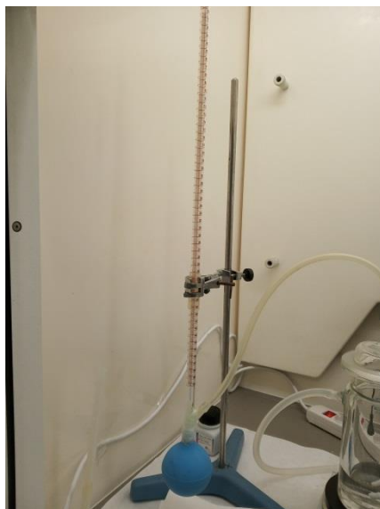
Imagen 3: Columna graduada sujeta por una abrazadera. Bajo esta, bola de coma de contiene la mezcla jabonosa. Fuente: elaboración propia.
