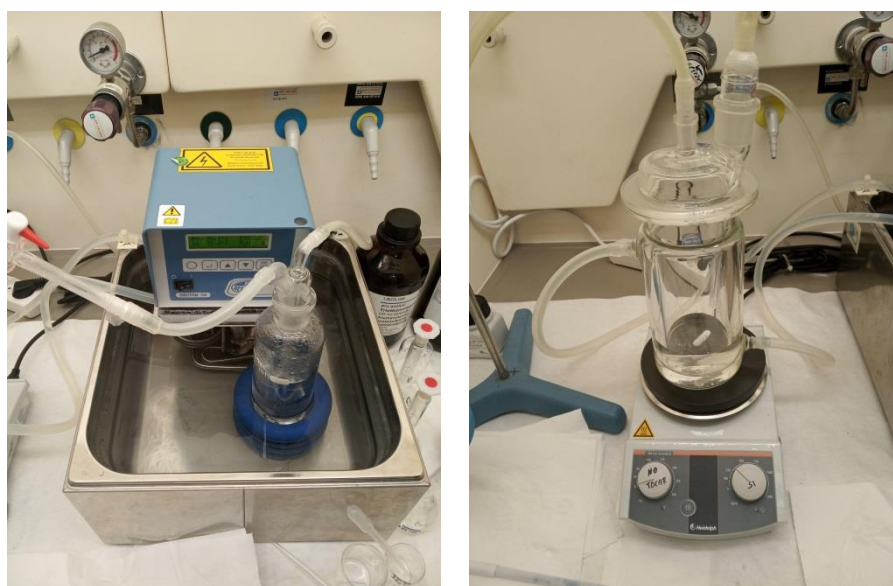
Imagen 2: A la izquierda, baño termostatzado, conectado al reflujo y al frasco lavador de gases. A la derecha, reactor de vidrio encamisado con tapa de dos bocas (con el spin magnético en el interior) conectado a reflujo, sobre un agitador magnético. Fuente: elaboración propia.
