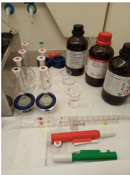
Imagen 1: A la izquierda frascos que contienen las distintas aminas, pipetas graduadas de clase A, aspiradores de 10 y 25 ml, vasos de precipitado de 50ml y matraces aforados de 100ml con aro metálico. A la derecha, equipo empleado en el interior de la campana extractora de gases. Fuente: elaboración propia.
