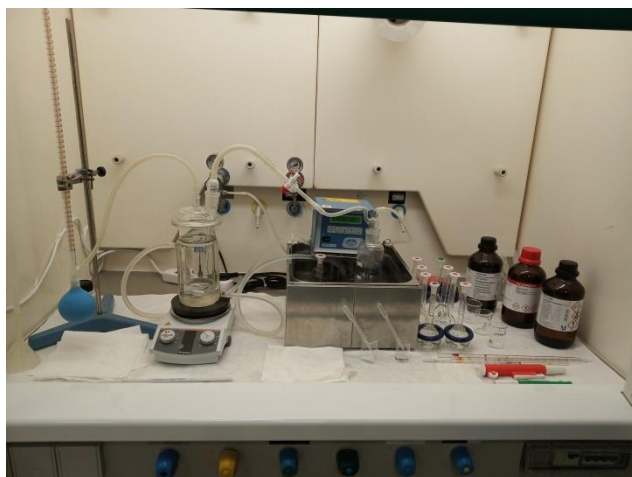
Imagen 1: A la izquierda frascos que contienen las distintas aminas, pipetas graduadas de clase A, aspiradores de 10 y 25 ml, vasos de precipitado de 50ml y matraces aforados de 100ml con aro metálico. A la derecha, equipo empleado en el interior de la campana extractora de gases. Fuente: elaboración propia.
