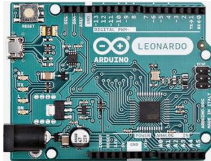
Ilustración 18 Placa Arduino Leonardo
