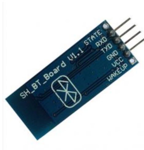
Ilustración 7 Parte trasera del módulo HC-06
