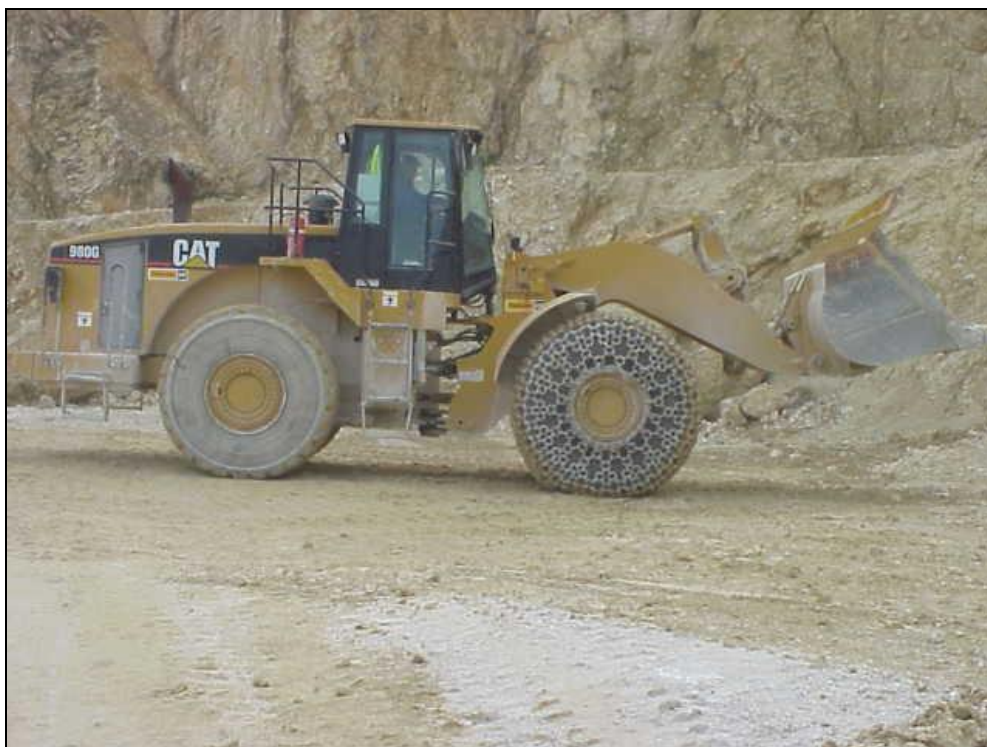
Figura 8.14.. Pala cargando en el frente
