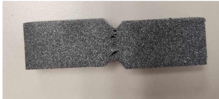
Ilustración 4.36: Rotura en una probeta de cortante para un ensayo válido
