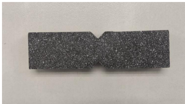
Ilustración 4.31: Probeta de cortante despues del moteado
