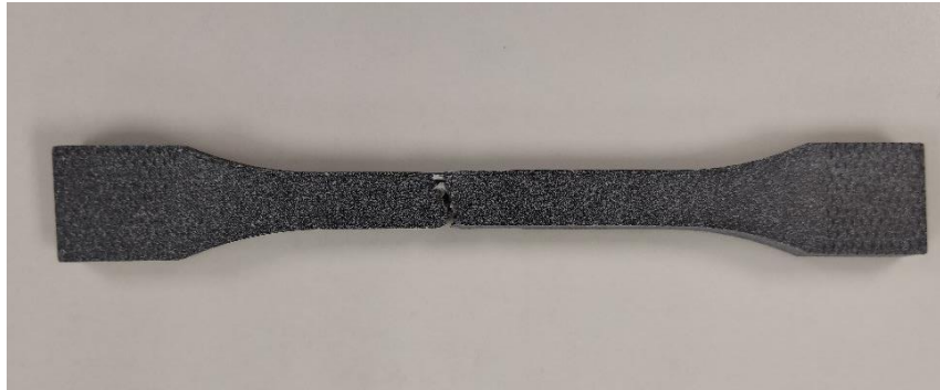
Ilustración 4.16: Rotura en una probeta de tracción para un ensayo válido
