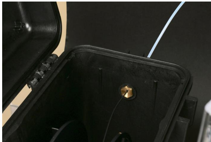
Ilustración 3.7: Orificio de salida de filamento de la caja Markforged
