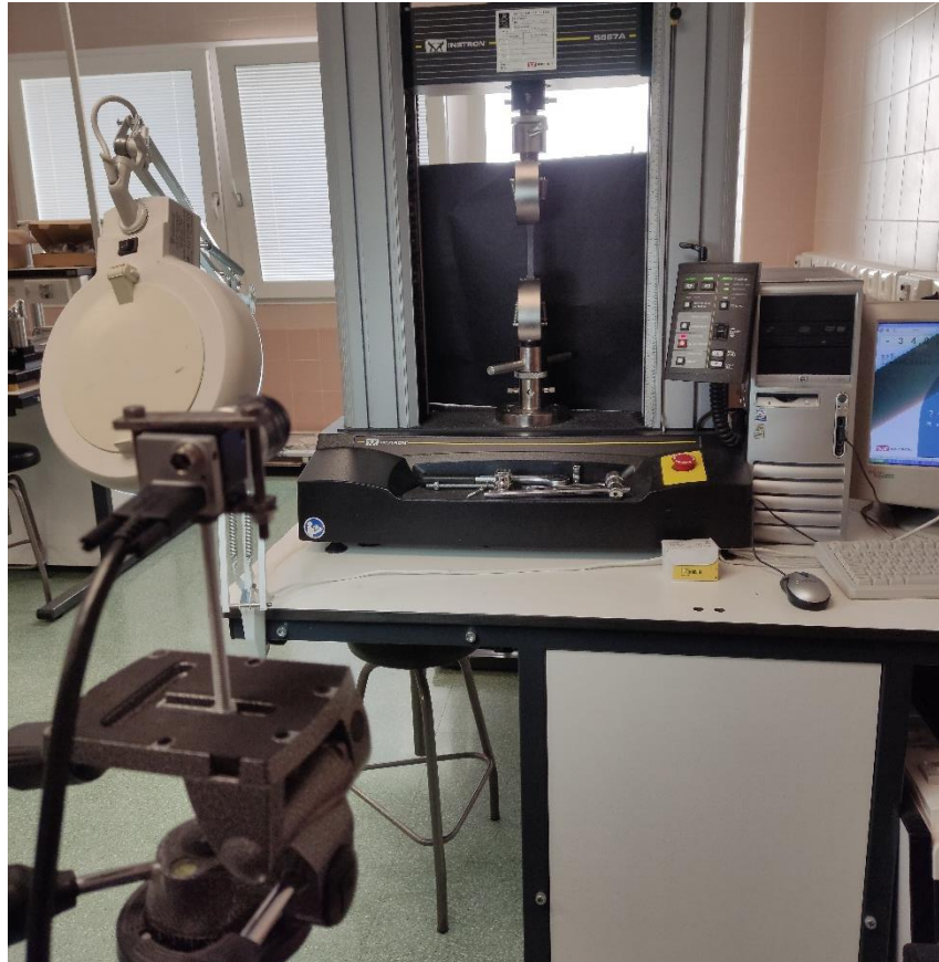
Ilustración 4.13: Montaje de equipo de toma de imágenes para ensayos de tracción
