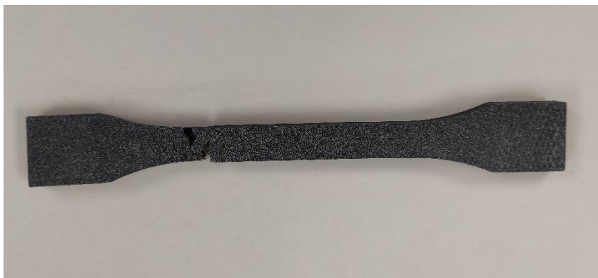
Ilustración 4.17: Rotura en una probeta de tracción para un ensayo no válido
