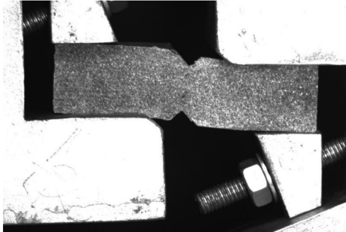
Ilustración 4.35: Probeta de cortante en las mordazas una vez finalizado el ensayo
