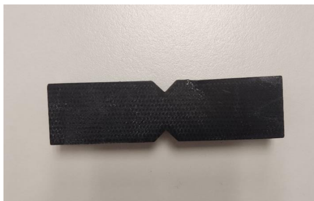
Ilustración 4.30: Probeta de cortante antes del moteado
