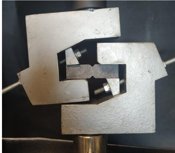
Ilustración 4.32: Probeta de cortante en las mordazas
