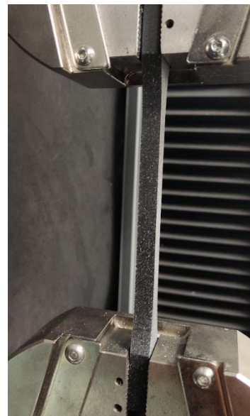
Ilustración 4.12: Probeta de tracción en las mordazas, vista lateral
