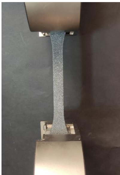
Ilustración 4.11: Probeta de tracción en las mordazas, vista frontal
