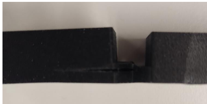
Ilustración 4.37: Rotura en una probeta de cortante para un ensayo no válido
