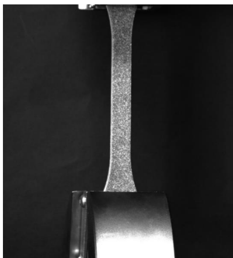
Ilustración 4.14: Probeta de tracción en las mordazas antes del ensayo
