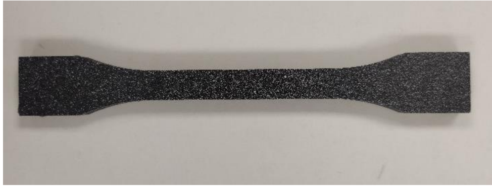
Ilustración 4.10: Probeta de tracción tras el moteado
