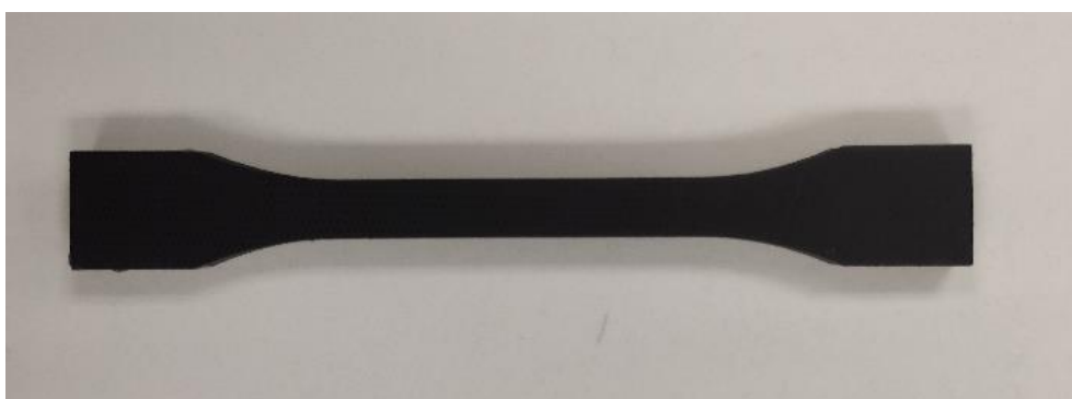
Ilustración 4.9: Probeta de tracción antes del moteado
