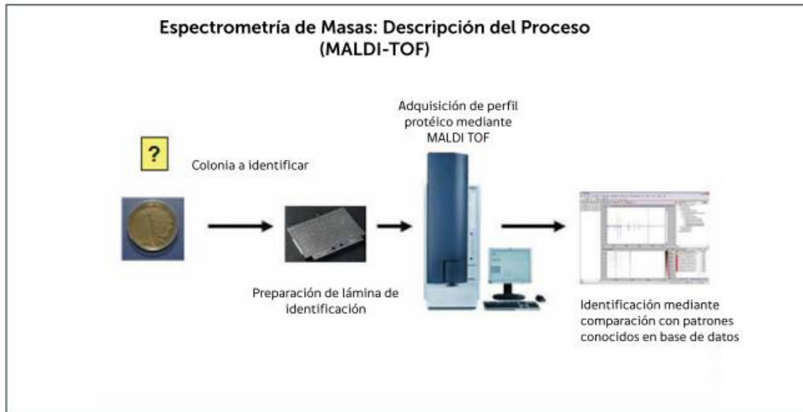
Imagen 5- Metodología de espectrometría de masas (MALDI-TOF)
