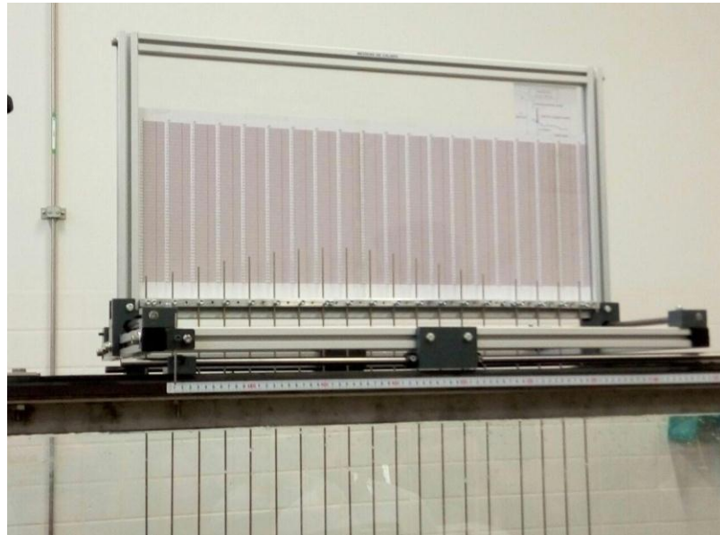
Fotografía 116-Sistema de medición de calado.
