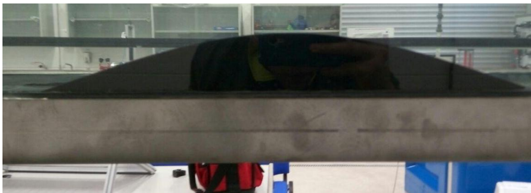
Fotografía 21-Resalto de fondo de 75 mm en la zona de ensayo del canal.
