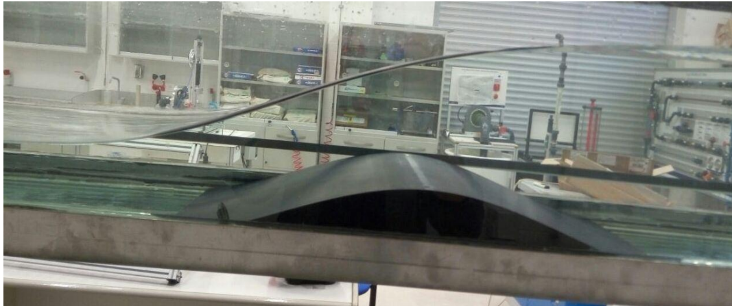
Fotografía 83-Contorno de la superficie libre de líquido realizado en el canal.
