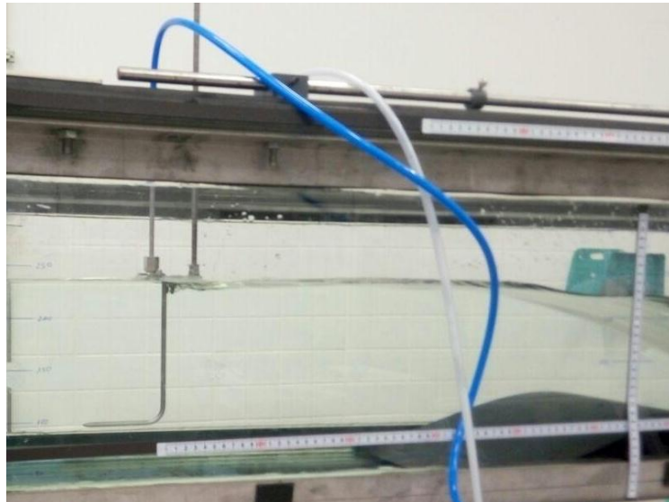
Fotografía 22-Medición de velocidad durante el ensayo.
