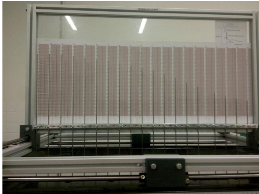
Fotografía 14-Sistema de medición de calado.
