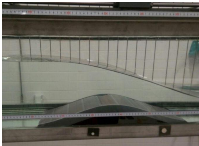
Fotografía 23-Varillas fijadas sobre la superficie libre de líquido durante la realización el ensayo.
