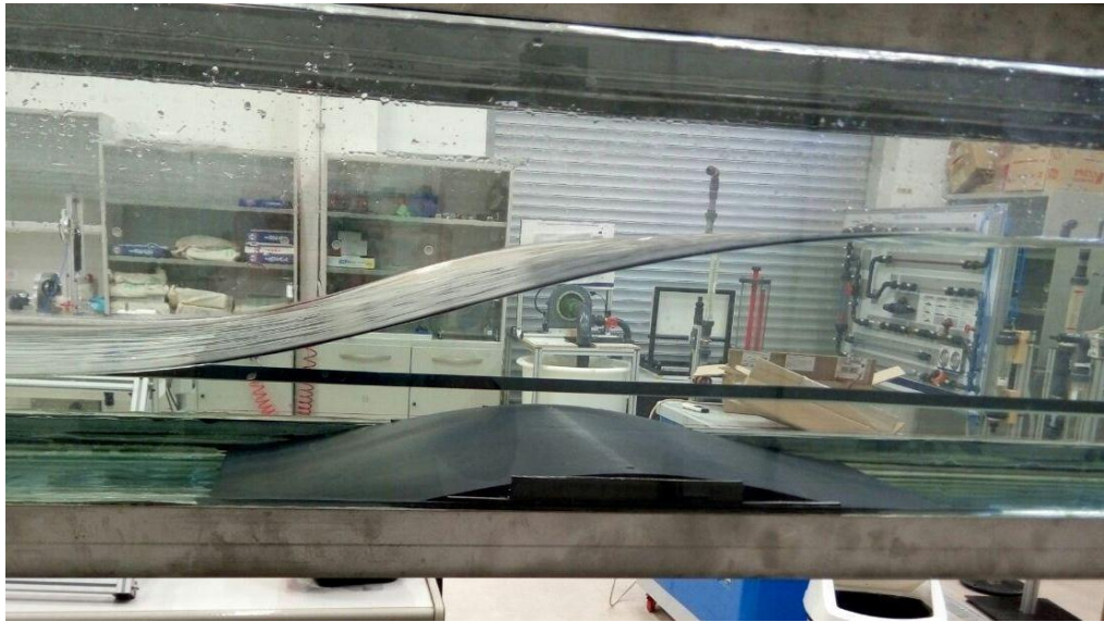
Fotografía 73-Contorno de la superficie libre de líquido durante el ensayo realizado en el canal.
