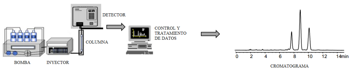
Figura 13. Componentes de un sistema HPLC/UHPLC.
