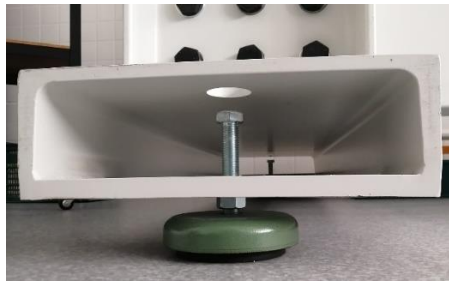
Figura 48. Apoyo del marco en la realidad.
