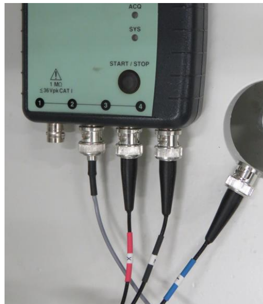
Figura 70. Canal 1 para martillo, 2,3 y 4 para acelerómetros.
