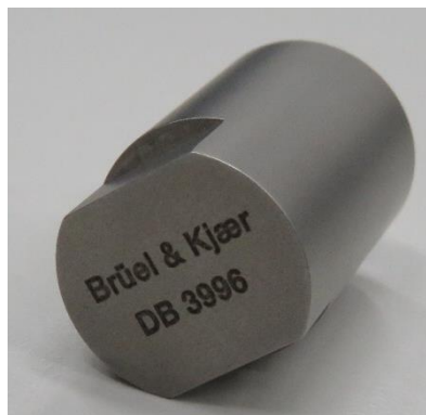
Figura 28. Masa extra que se atornilla al martillo.
