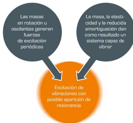
Figura 2. Condiciones por las que aparecen vibraciones.
