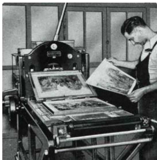
Fig. 13. Obtención de una imagen por el proceso de fotograbado.
