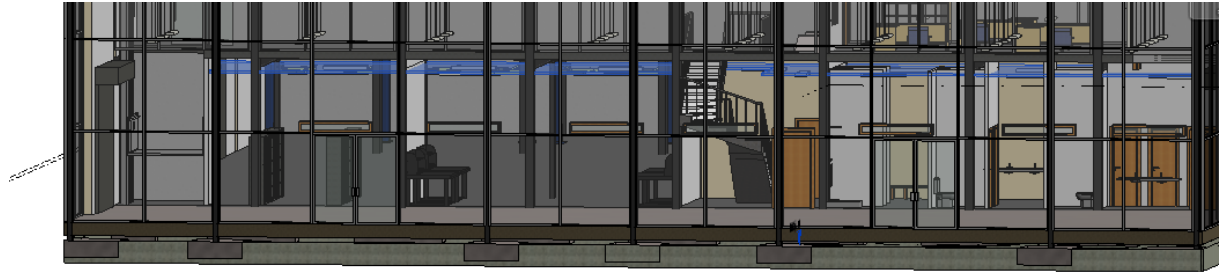
Figura 91. Hueco entre forjado planta superior y techo planta inferior
