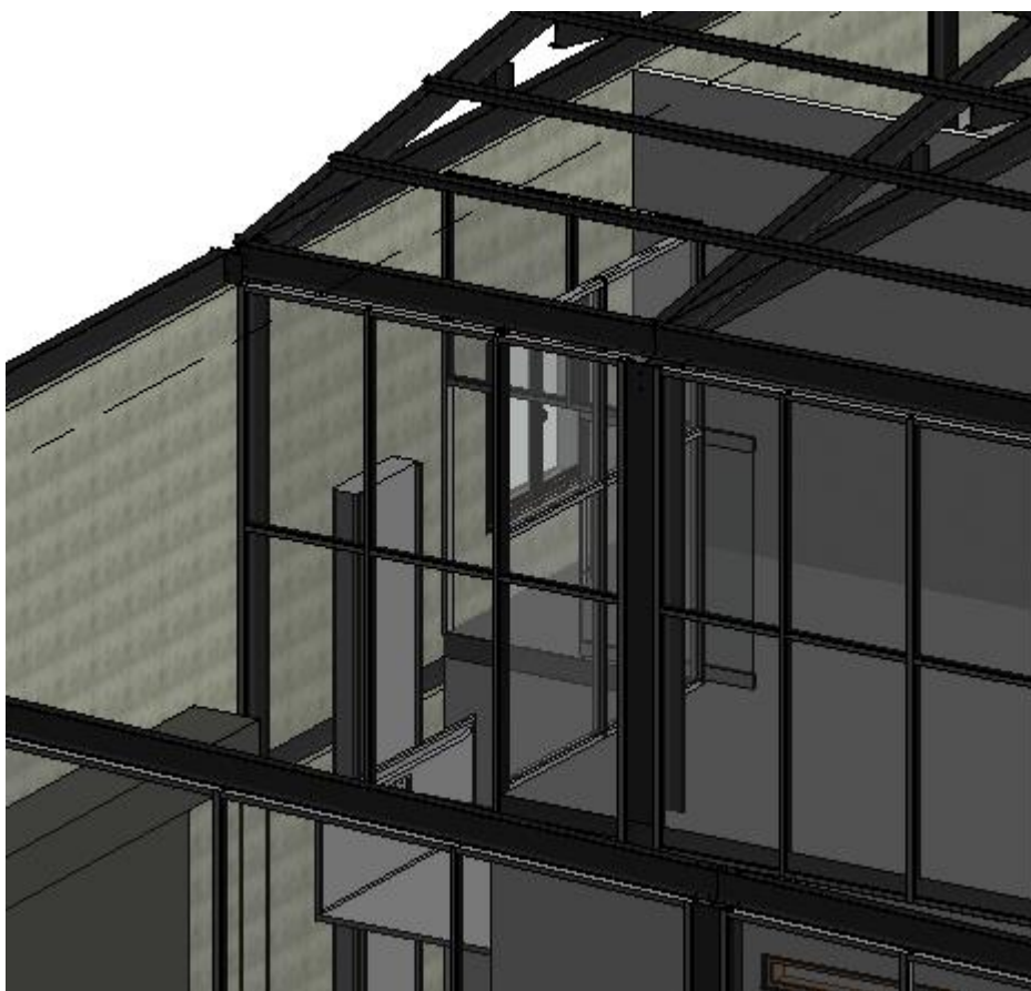
Figura 76. Cerramiento del hueco del elevador vista desde el interior
