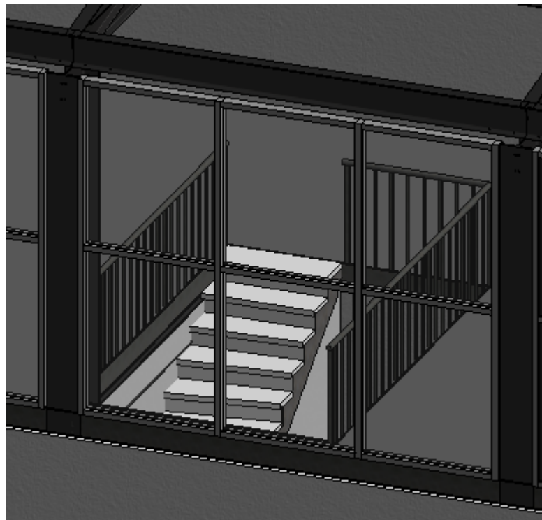
Figura 83. Barandilla del hueco de la escalera
